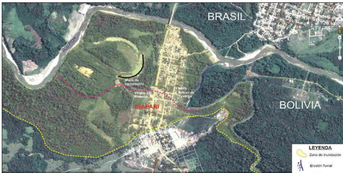
Figura 7.22 Se observa el área de color amarillo, zona sujeta a inundación. Parte del poblado Iñapari se encuentra dentro de esta zona. En color magenta se indica la zona afectada por inundación en el año 2012.
