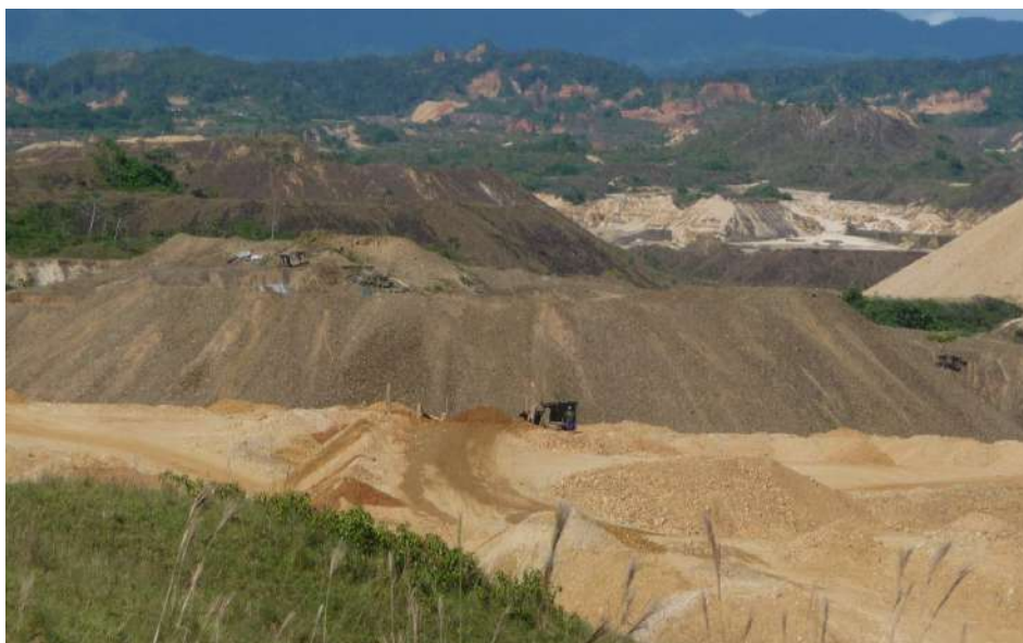
Fotografía 4.10 Montículos de sedimento producto de la actividad minera fluvial. Fotografía tomada en sureste de Huaypetuhe.
