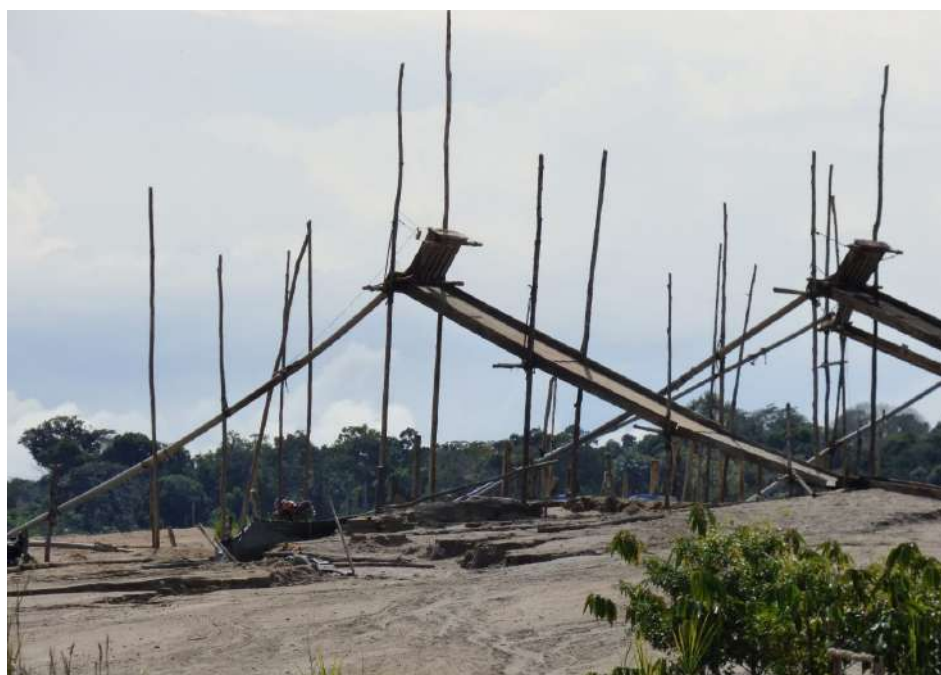
Fotografía 4.11 Tomada cerca al poblado de Nueva Arequipa, se observa “chutes” para la extracción de oro aluvial.
