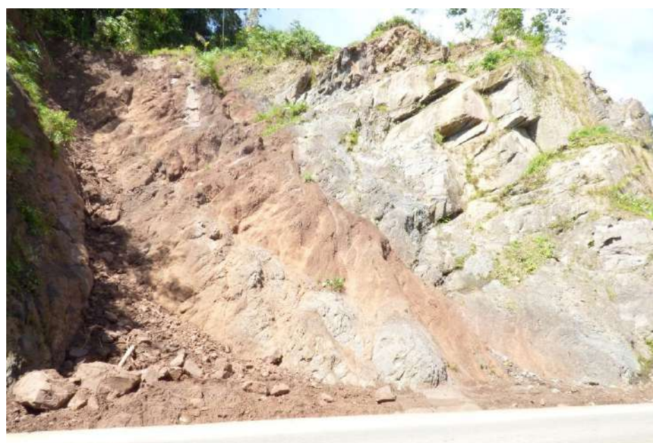
Fotografía 3.9 Vista tomada con dirección sureste. Se observa afloramiento de areniscas grises y marrones, de grano medio, en estratos medianos con contenidos de materia orgánica con intercalaciones de limoarcillitas marrones a parduzcas, arcillosas, de la Formación Chambira, en el sector Puente Tazón, confluencia de las quebradas Palmera y río Inambari.
