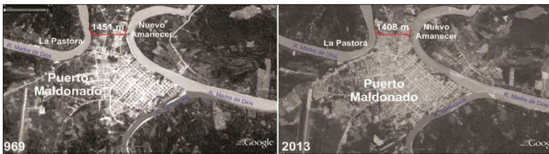
Figura 7.10 Comparación de imágenes de los años 1969 y 2013 consultada del Google Earth. En 44 años la distancia entre los meandros de los sectores La Pastora y Nuevo Amanecer se ha reducido hasta 43 m aproximadamente.
