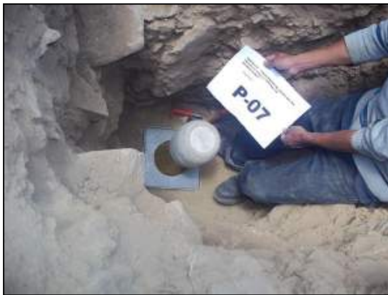
Figura 9. Excavación Exploratoria P-7 en el Sector Tres Cruces, los materiales granulares corresponden a Gravas arcillosas de clasificación SUCS GC
