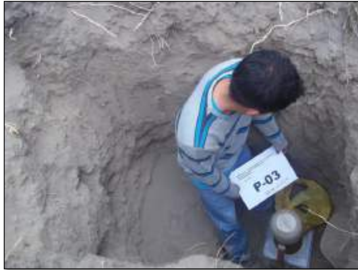
Figura 5. Excavación Exploratoria P-3 en el Sector Las Vegas, los materiales granulares corresponden a Arenas Limosas de clasificación SUCS SM - SC
