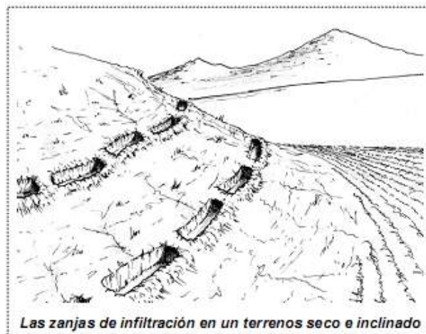
Figura 6. Zanjas de infiltración
