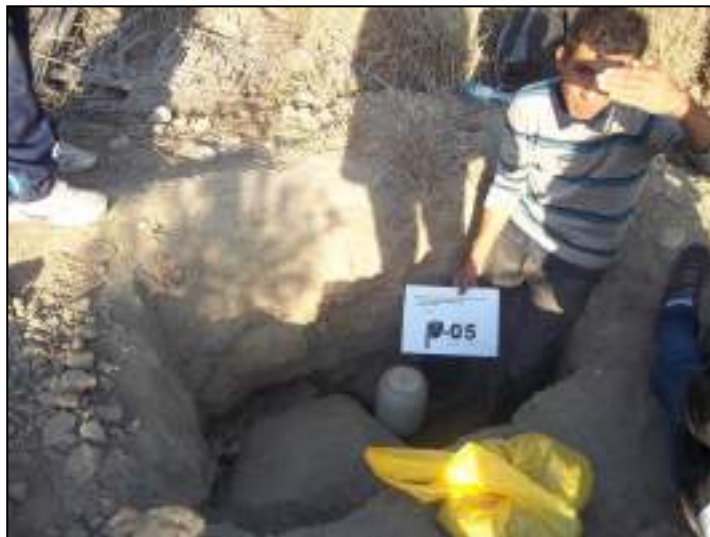
Figura 7. Excavación Exploratoria P-5 en el Sector San Telmo, los materiales granulares corresponden a Arenas mal gradadas de clasificación SUCS SP
