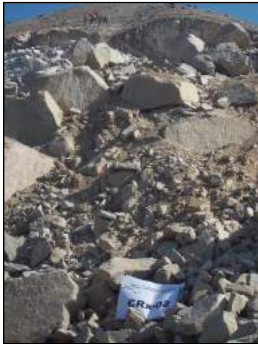
Figura 14. Afloramiento rocoso de la cantera Vinto, de diámetros que superan 1.00 m., la explotación deberá realizarse mediante voladura controlada
