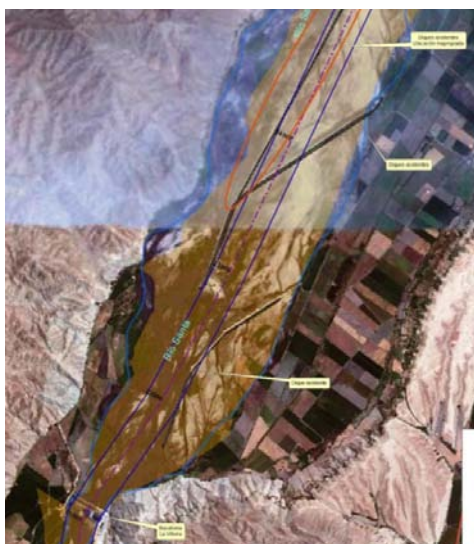
Figura 5. Defensas ribereñas mal ubicadas en el cauce
