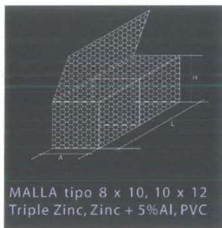
Figura 1. Gaviones tipo caja
