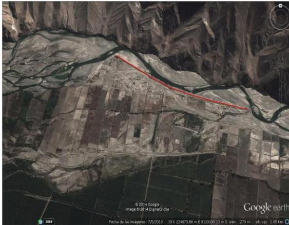
En la presente imagen se puede ver al dique enrocado existente en el Sector La Haciendita, de 988 metros lineales de longitud. Este dique estrangula el cauce del río Tambo en el punto inicial a 129.24 m. de ancho y en la parte final a 58.42 m. de anchos; anchos de cauce de río que son muy inferiores al ancho estable del río.
