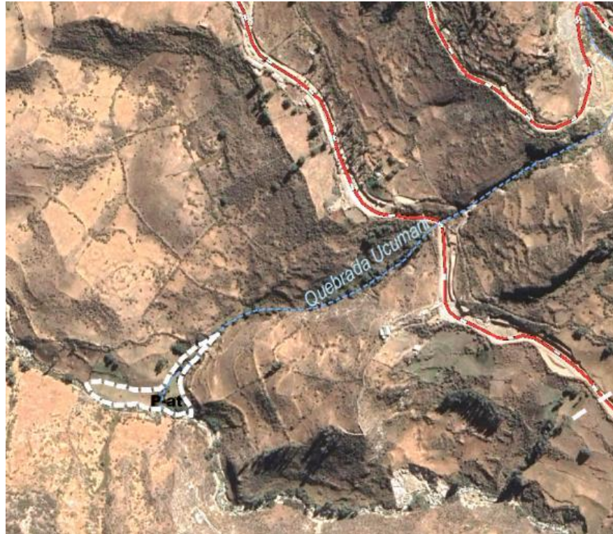
Figura 13. Vista panorámica de la subunidad de vertiente aluvio-torrencial (P-at) formado por la acumulación de material proluvial relacionado a flujos de detritos (huaicos). Es evidente que la geoforma de cono de deyección que presenta la quebrada Ucumani, que discurre hacia el río Patón (Imagen Google Earth, 2020).
