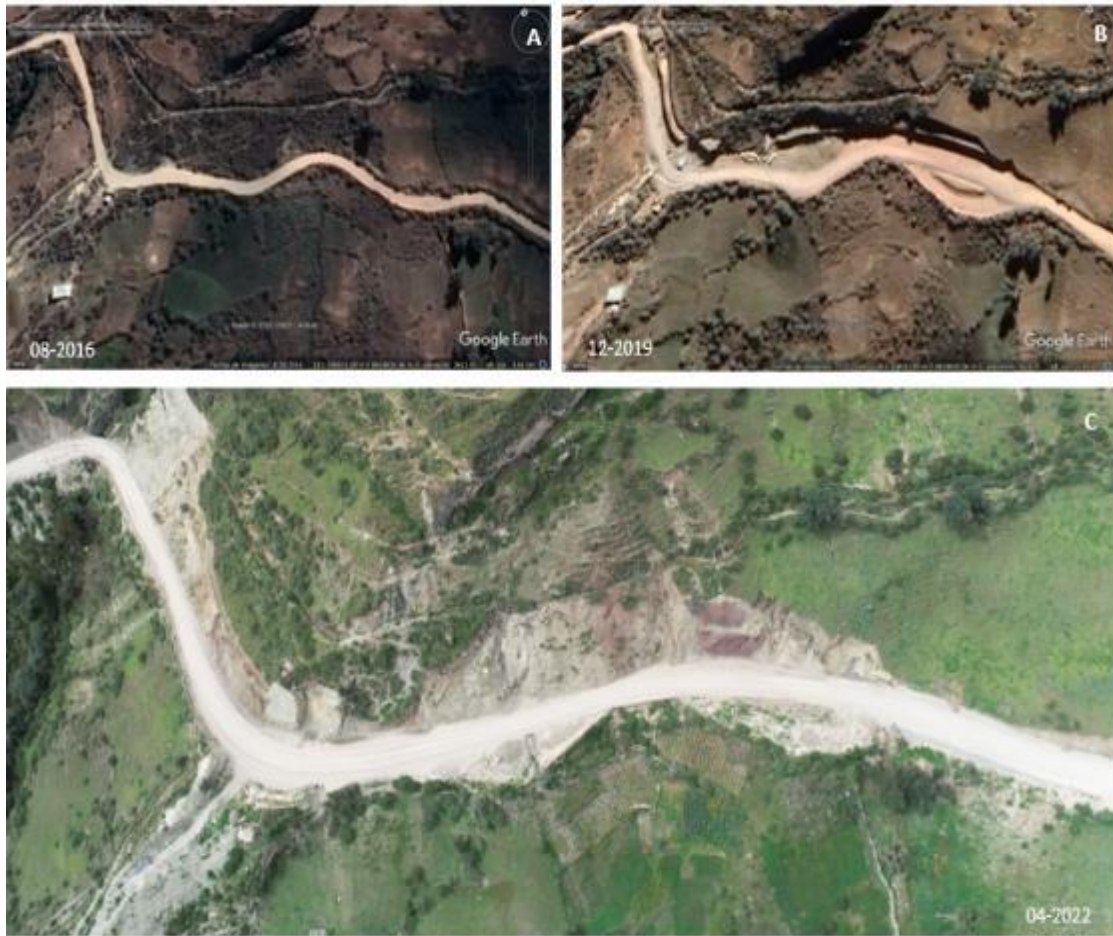
Figura 18. Vista de imágenes multitemporales para los años 2016 (A), 2019 (B) y 2022 (C); donde se observa la evolución de erosión y movimiento en masa (deslizamiento) así como el tipo y estado de carretera en evaluación (trocha a afirmada)
