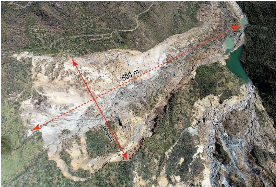
Figura 16. La masa deslizada presenta un ancho de 160 m y una longitud de 500 m aproximadamente, la cual se moviliza sobre una superficie de falla rotacional con dirección preferente al noroeste.
