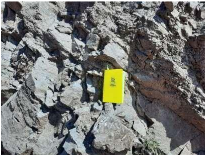
Fotografía 2. Vista de areniscas tabulares muy fracturadas y ligeramente meteorizadas en el corte de carretera departamental CU-117. Ubicadas en las cordenasas UTM: X: 183636 Y:8489963.
