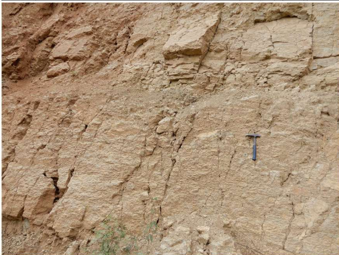
Figura 3. Valor GSI estimado para la secuencia de calizas, margas y limorcillitas con estructura fracturada a perturbada y espaciamentos próximas entre sí (0.10 – 0.20 m), abiertas (1.0 – 3.0 mm) y de resistencia baja (25-50 Mpa).
