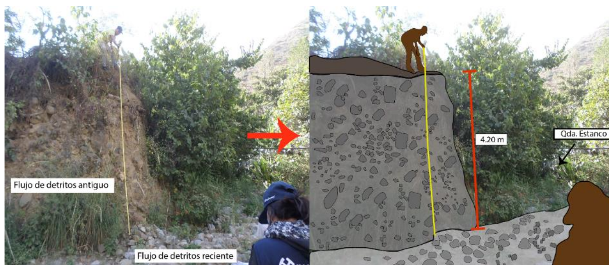
Figura 18. Vista del depósito de flujo de detritos antiguo con espesor de 4.20 m, conformado con fragmentos de rocas angulosos a subangulosos, que van de 0.5 cm a cantos con 40 cm envueltos en una matriz areno limoso.
