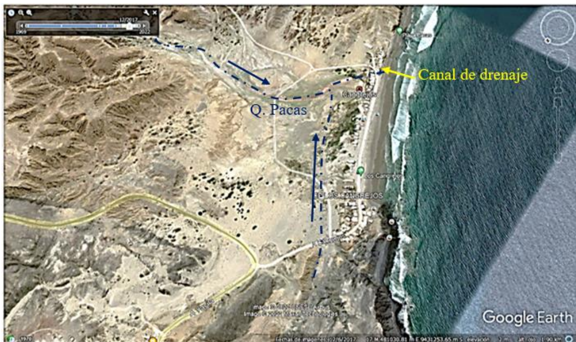
Figura 25.- Quebradas Pacas y la situada en el extremo noroeste de Playa Cangrejos que drenan las aguas pluviales hacia la llanura eólica y posteriormente a través de un canal encausado con lozas de concreto hacia el mar, (Google earth, 2017)
