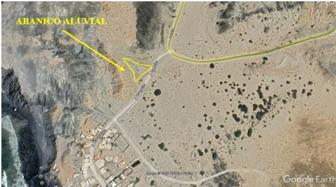
Figura 10.- Abanico aluvial (polígono amarillo) situado en la vía de ingreso hacia la playa Los Cangrejos, específicamente a 200 m hacia el noreste de las viviendas.
