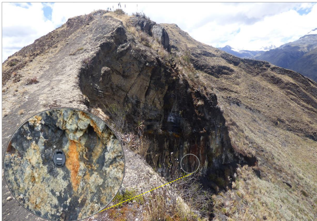
Figura 2. Areniscas, lutitas pizarrosas muy meteorizadas, con contenido de oxido y ligera presencia de carbón.
