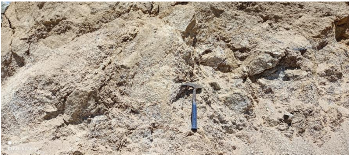
Fotografía 1. Granito fuertemente fracturado y meteorizado que aflora en la parte baja del deslizamiento.
