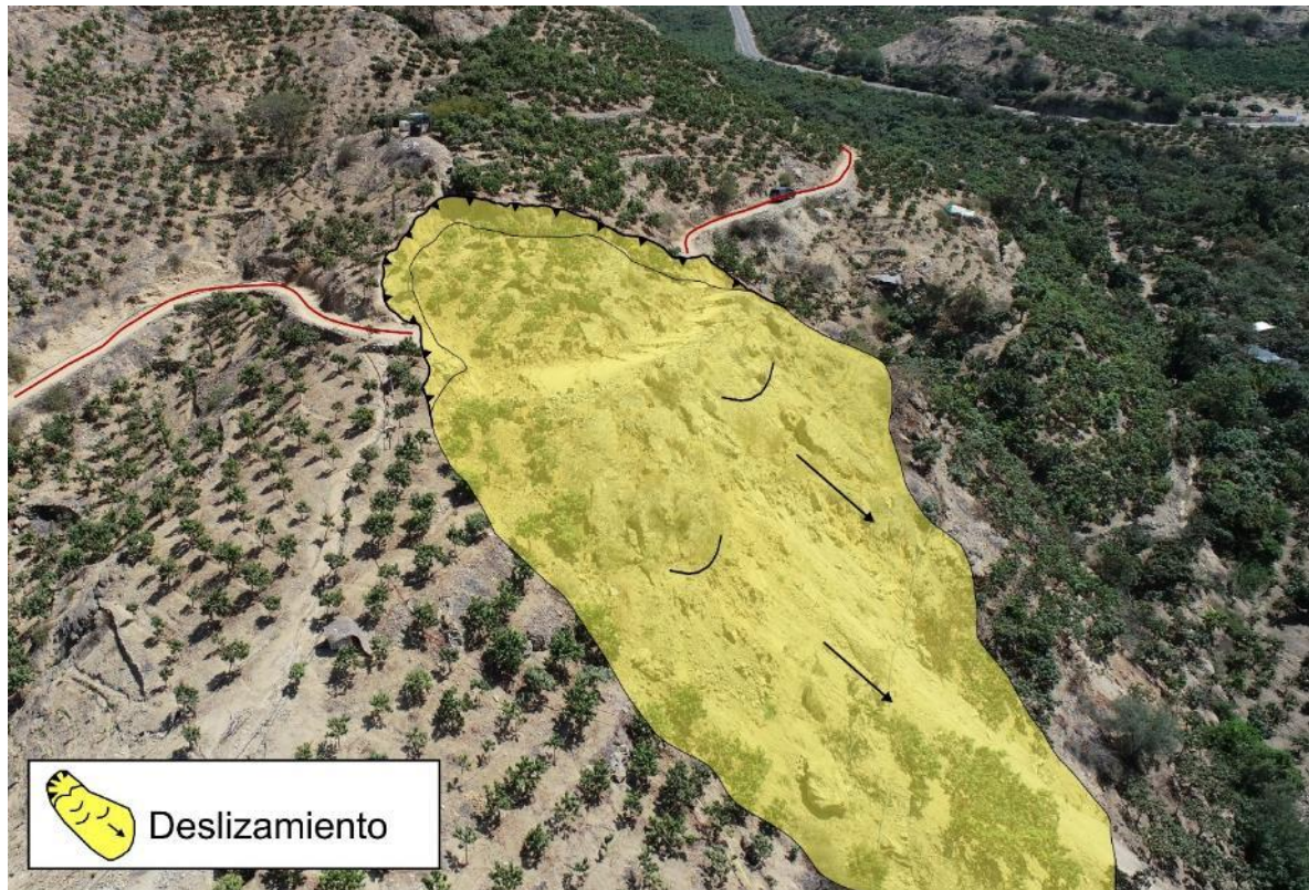
Figura 12. Vista aérea del deslizamiento (DRA) en el caserío Mishiruri.
