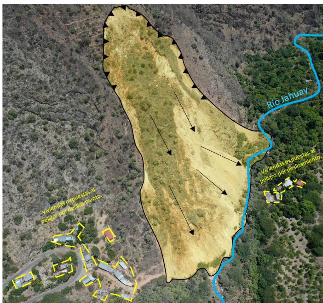
Figura 7. Vista panorámica del deslizamiento (línea negra), se puede apreciar las viviendas expuestas al peligro por deslizamiento y ante un posible embalse del río Jahuay (líneas punteadas amarillo).
