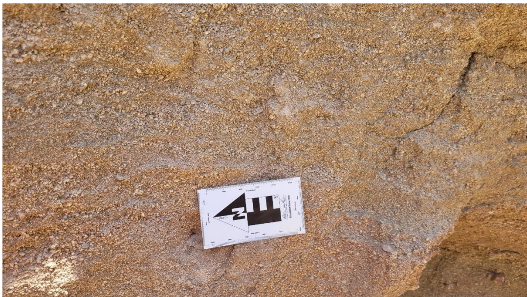
Fotografía 3: Se observa el depósito aluvial, constituido por arenas limosas y gravas. Coordenada UTM WGS-84, 18S: E: 169494; N: 9241261; altitud:1152 m s.n.m.
