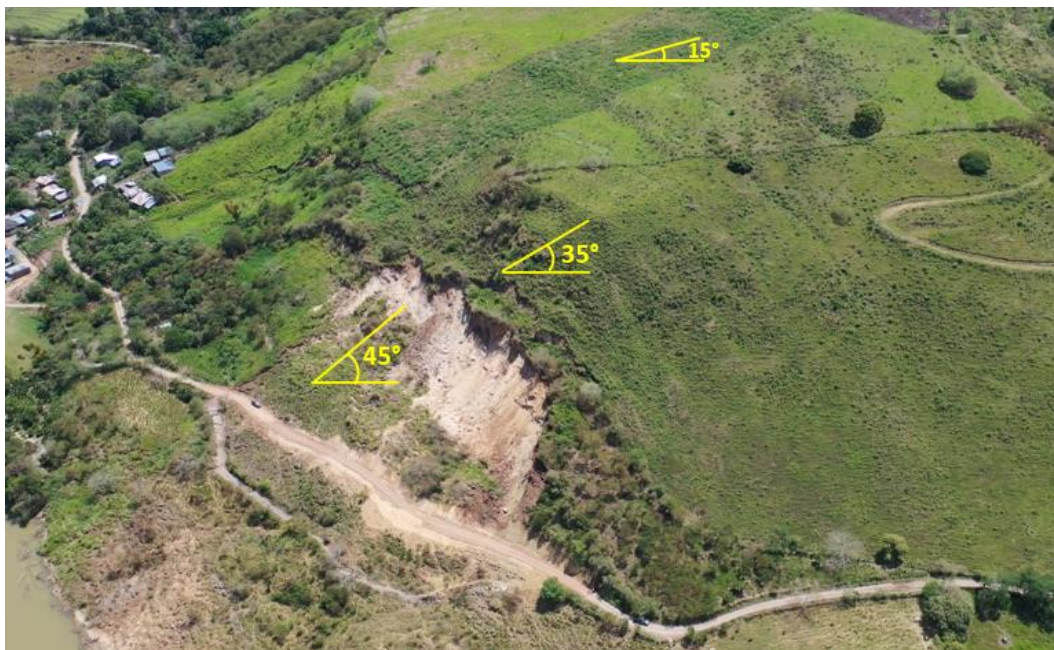
Figura 4. Variación de pendientes (terrenos inclinados de pendiente moderada y fuerte de 25^\circ a 45^\circ ), en el caserío San Juan de Dios.
