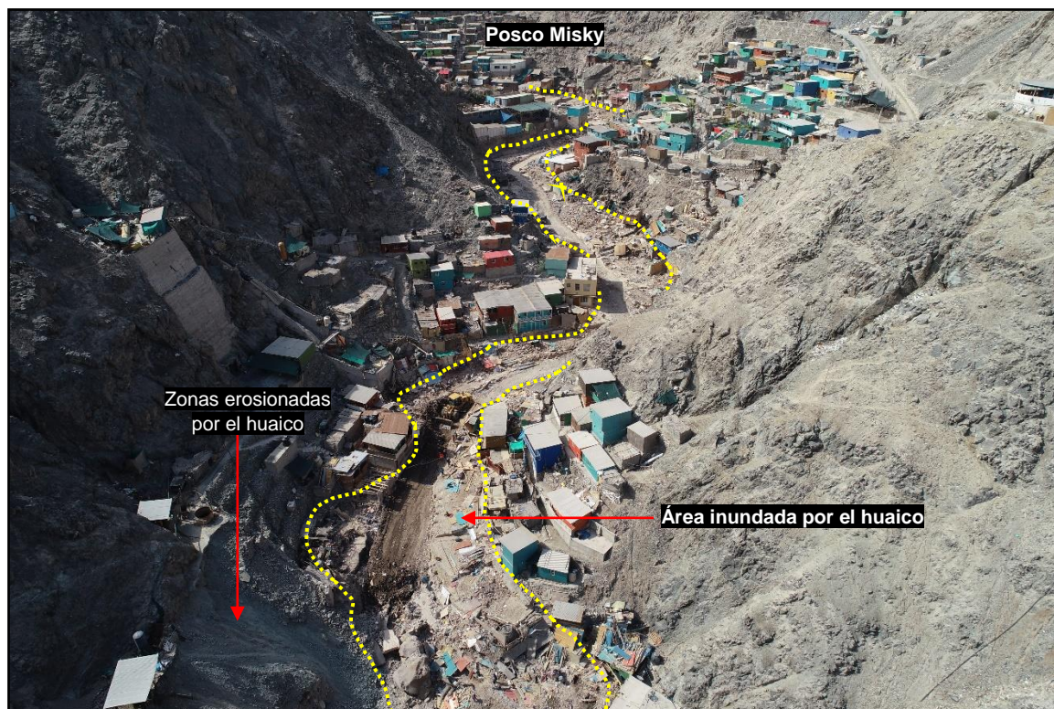
Figura 54. Área inundada por huaico y zonas erosionadas, sector Posco Misky.
