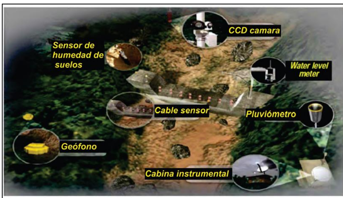
Figura 79. Sensores utilizados para el monitoreo de flujos de detritos (fotografía tomada de Soil and Water Conservation Bureau SWCB-Taiwan, por Vílchez, 2010).
