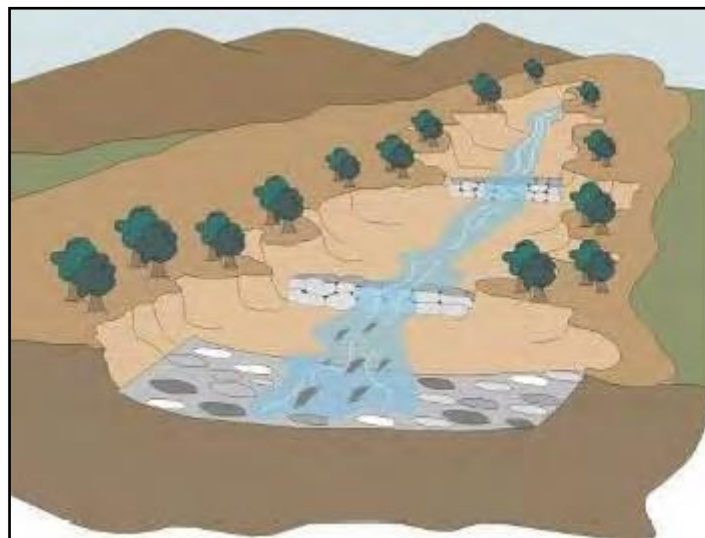
Figura 77. Presas transversales a cursos de quebradas y crecimiento de bosques Ribereños, (Vilches, 2021)
