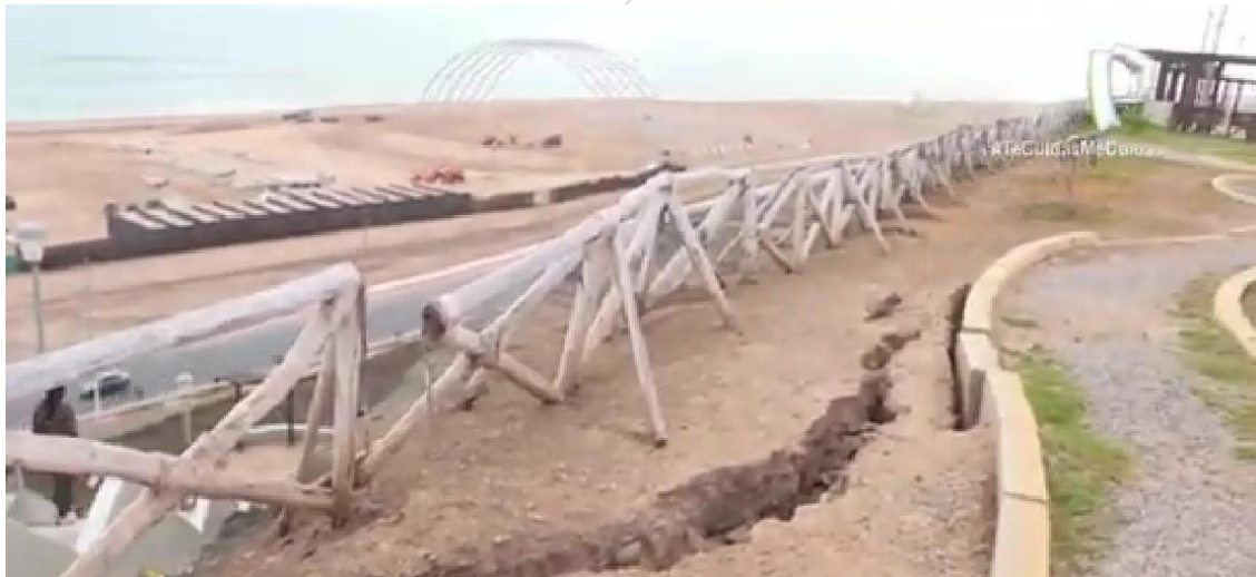
Figura 259. Escarpes activos con desplazamientos de 10 a 30 cm con dirección hacia el acantilado. Fuente: Panamericana.pe
