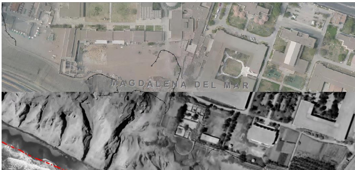
Figura 297. Comparación de la ortofoto del año 1943 y la ortofoto actual donde se proyectaron escarpes de arranque de antiguas cárcavas.
