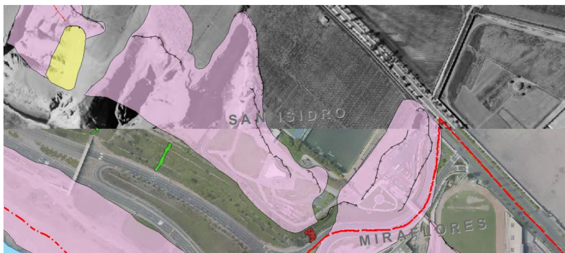
Figura 315. Ortofoto del año 1943 y la ortofoto actual donde se proyectaron escarpes de arranque de antiguas cárcavas.
