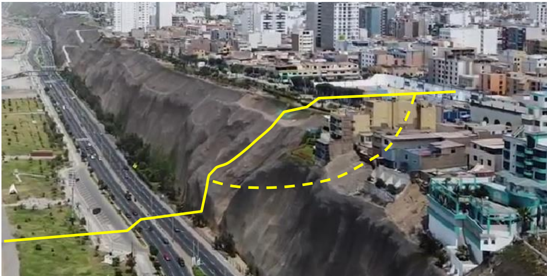
Figura 292. Acantilados de Magdalena y el Coliseo Aldo Chamuchumbi donde se infiere una potencial zona de deslizamiento. Línea continua (superficie del terreno) y línea puntuada (superficie antigua del terreno en 1960)
