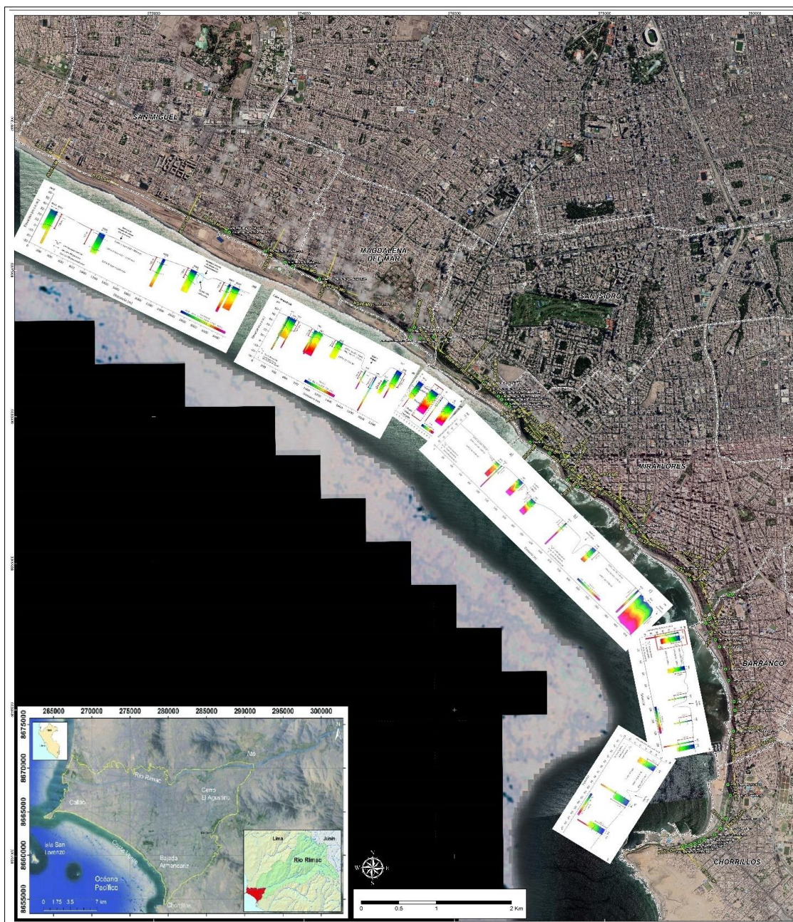
Figura 27. Imagen satélite con información de ubicación y resultados de la información de sísmica de refracción adquirida por el IGP.
