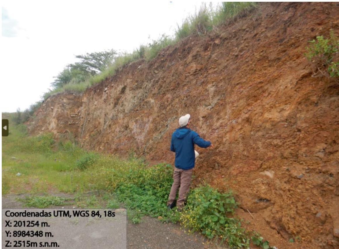
Figura 7. Rocas lutitas (verdes y rojizas) fragmentadas y completamente meteorizados.
