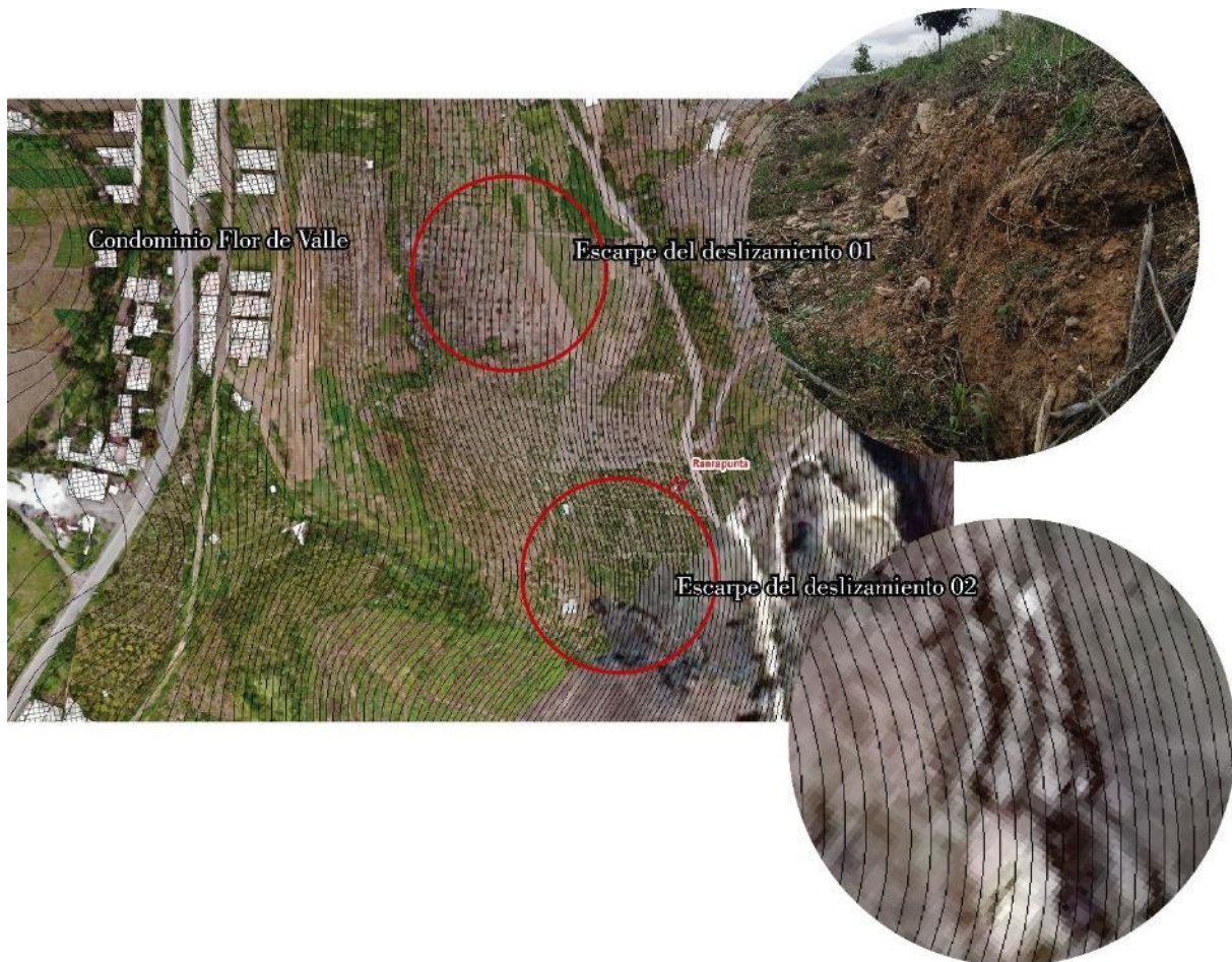
Figura 19. Muestra los escarpes principales de los deslizamientos 01 y 02 en referencia con el condominio Flor del Valle.
