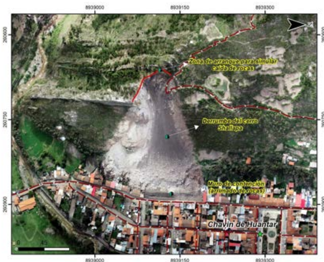
Figura 15. Ubicación de la zona de arranque para simular caída de rocas con el software Rockfall.
