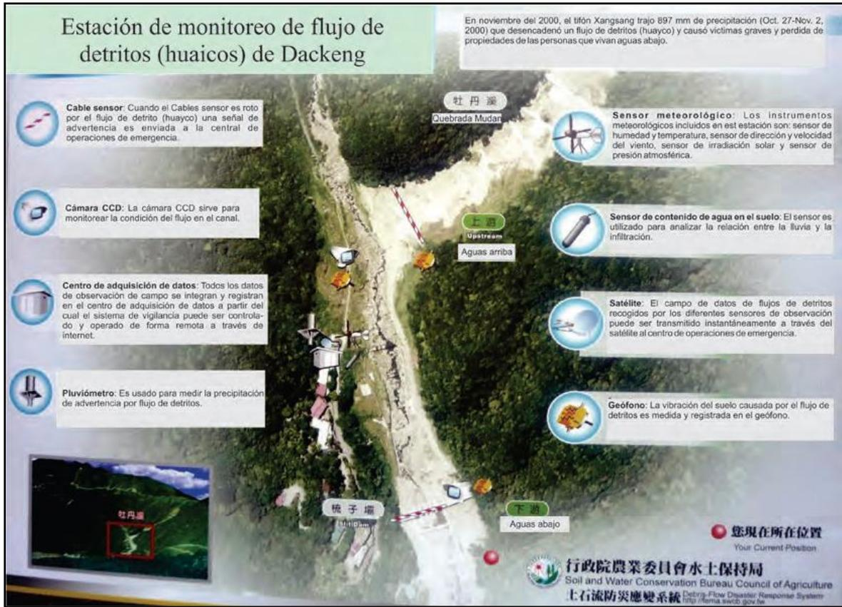
**Figura 41.** Estación de monitoreo de flujo de detritos (fotografía tomada de Soil and Water Conservation Bureau SWCB-Taiwan, por Vílchez, 2010).
