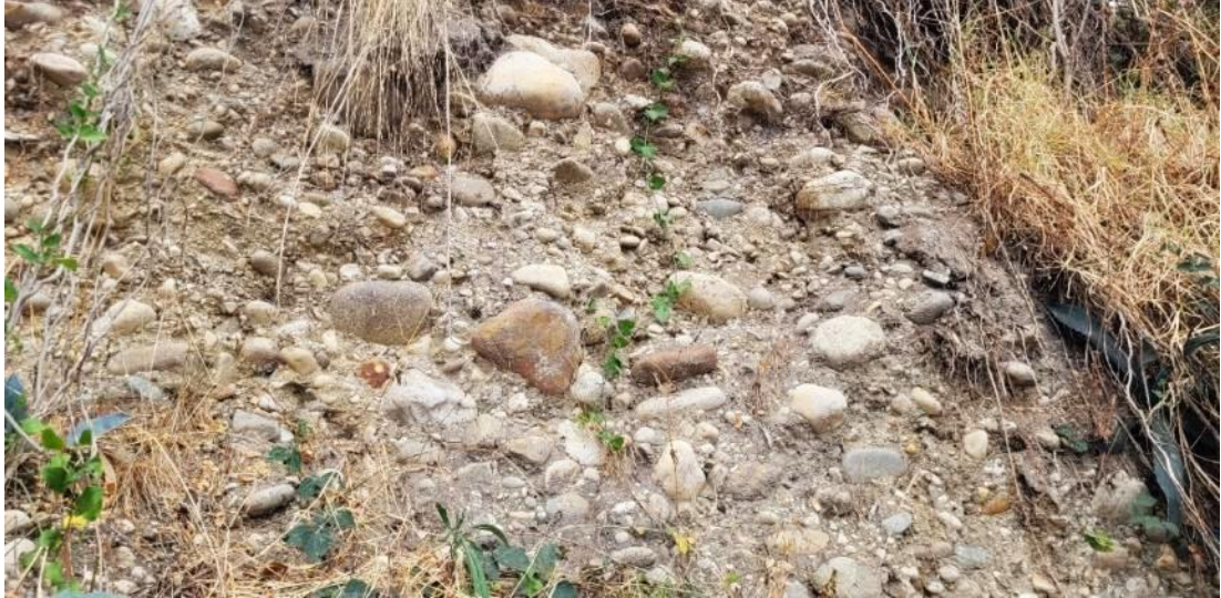
Fotografía 3. Depósito aluvial, compuesto de bloques, cantos, gravas, gránulos, arenas, limos y arcillas.
