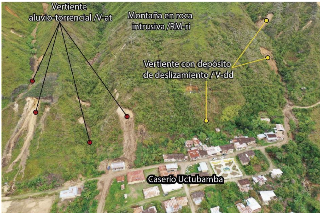
Figura 15. Se observa la ladera suroeste del cerro C°1, y las unidades geomorfológicas que lo conforman.
