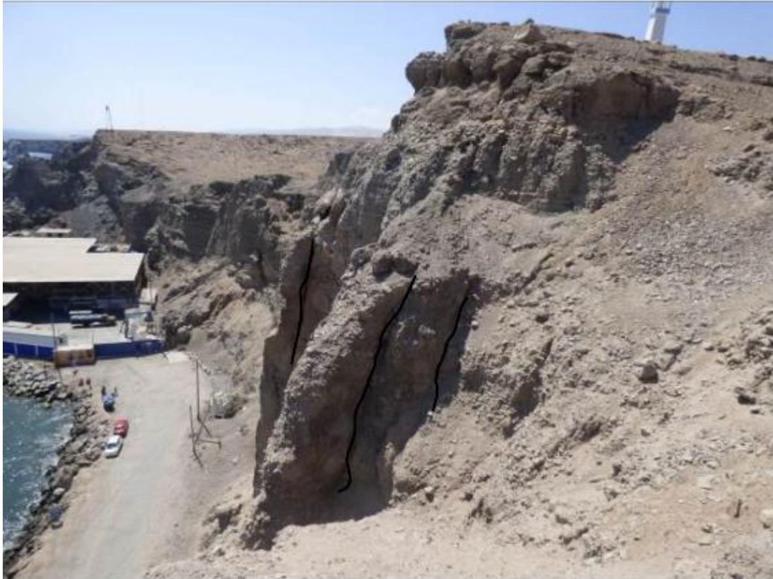
Figura 10. Vista tomada hacia el Norte, se observa afloramiento de la Fm. Millo conformado por conglomerados, areniscas tobáceas, lentes de tobas retrabajados, se aprecia grietas con dirección noroeste 10°, con presencia de lluvias que ocurren durante los meses de setiembre a octubre, estas aguas se infiltran, saturando y erosionando los sedimentos más finos debilitando el talud. Informe Técnico N°A6713, INGEMMET (2016).
