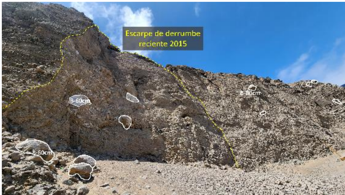
Figura 6. Escarpe de derrumbe reciente del 2015 en el sector Muelle Pesquero de Matarani.
