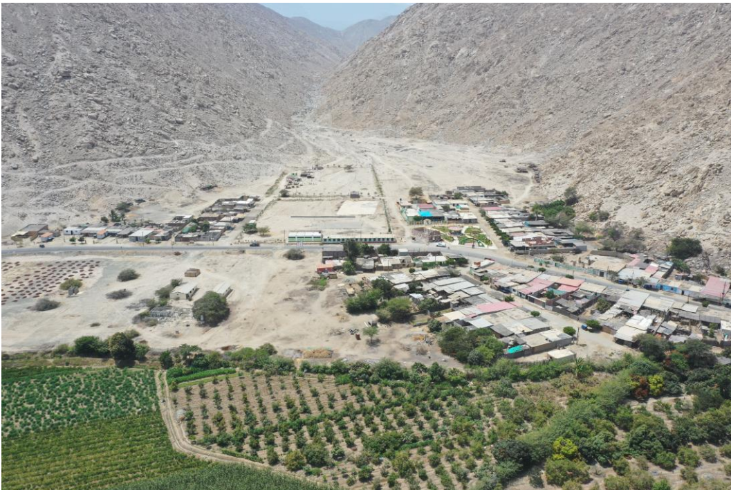
Fotografía 2. Depósitos proluviales donde actualmente se encuentra asentado el poblado de María Cristina. Se presentan depósitos semiconsolidados.
