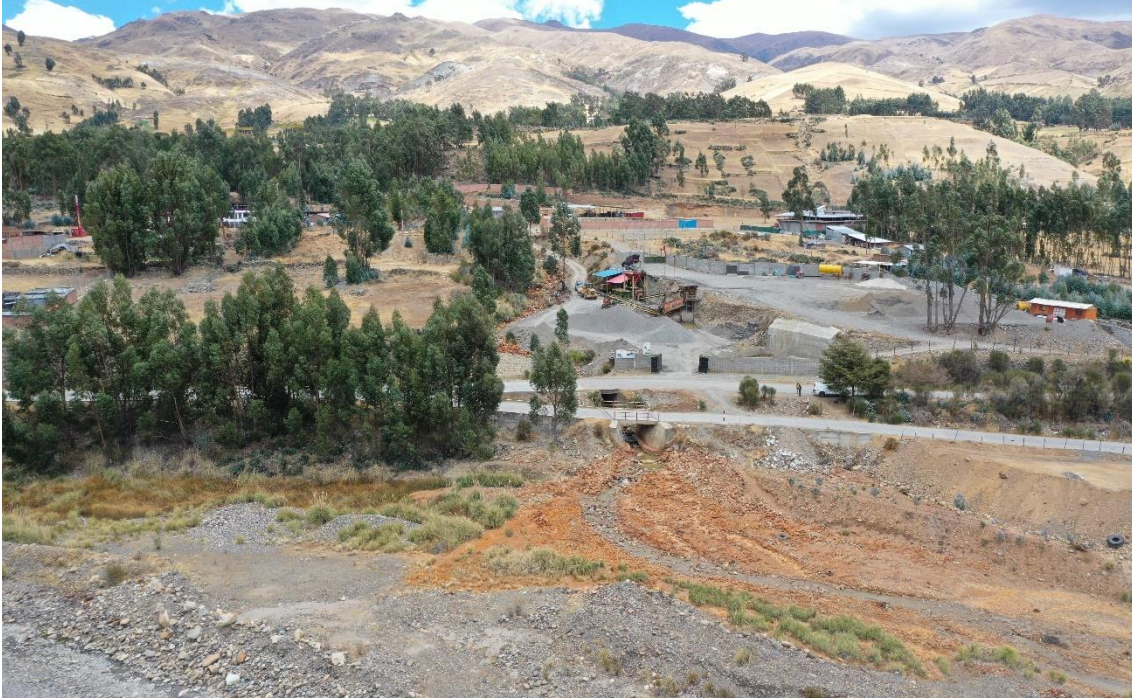
Fotografía 80. Zona crítica 02-102. El cauce de la quebrada Casa Cancha es susceptible a flujo de detritos, que se canalizaron por la quebrada hasta llegar al río Santa, desbordando lodos y agua en las cercanías del poblado.
