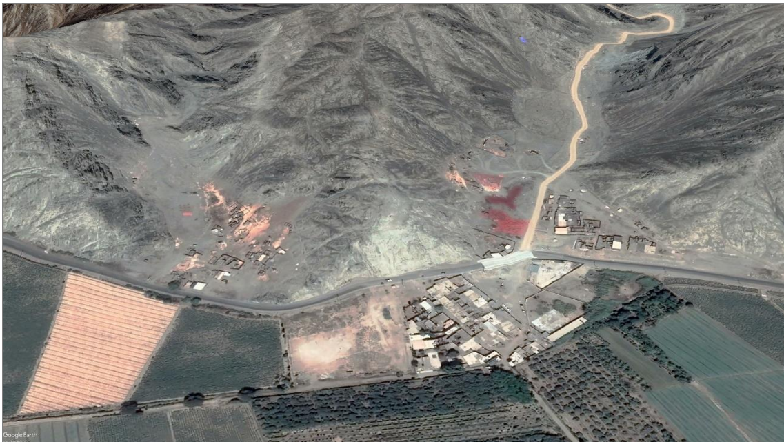
Figura 23. Zona crítica 02- 125. El poblado de Congón, se ubica en la desembocadura de una quebrada sin nombre que acarrea flujo de detritos en temporada de lluvias intensas y/o extraordinarias, afectando viviendas, terrenos de cultivo y vías de acceso. Coordenadas UTM: 8889580 / 820031, Zona 17 L. Tomado del Google Earth.
