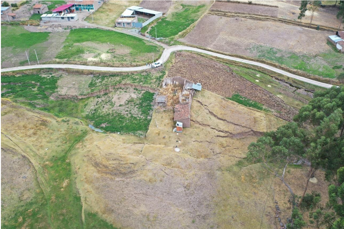
Fotografía 38. Zona crítica 02-100. El sector Lloclla o Lloclla Alto se ubica en la margen derecha de la quebrada Lloclla, que desciende al centro poblado Acos y vierte sus aguas al río Santa. Se observa afectación por reactivación de un evento antiguo en deslizamiento. Coordenada UTM: 8934100 / 227880, Zona 18 L. Tomado el 05-09-2023.
