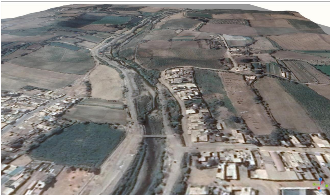
Figura 25. Zona crítica 02- 127. EL Arenal, se encuentra en el extremo este de la provincia de Huarmey aquí el cauce del río Huarmey conforma curvas a lo largo de su cauce, al ser la desembocadura del río en el área costera este, deposita una gran cantidad de sedimentos arrastrados desde tierras altas durante un largo período de tiempo. Zona susceptible a flujo de detritos e inundación fluvial.
