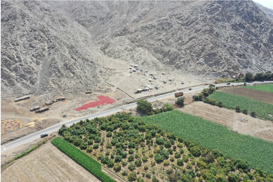
Fotografía 95. Zona crítica 02- 120. Cementerio ubicado en el cono proluvial, formado por la acumulación de flujo de detritos antiguos. Coordenadas UTM: 8892278 / 172990, Zona 18 L. Tomado el 12-09-2023.
