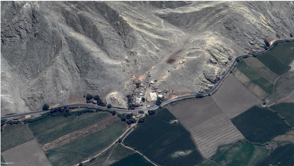
Figura 21. Zona crítica 02- 119. El poblado se ubica en un abanico proluvial formado por la acumulación de sedimentos detríticos provenientes de una quebrada con una alta concentración de dicho material, en temporada de lluvias intensas y/o extraordinarias se activa en flujo de detritos afectando viviendas, terrenos de cultivo y vías de acceso. Coordenadas UTM: 8892099 / 174976, Zona 18 L. Tomado del Google Earth.
