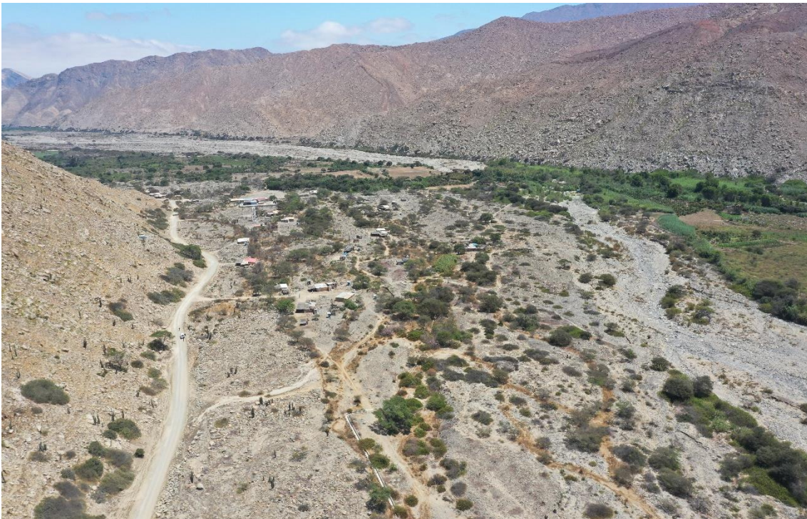
Fotografía 107. Zona crítica 02-139. Se encuentra asentado en el extremo izquierdo del cauce antiguo de río Culebras. Zona susceptible a ser afectada por flujo de detritos, se conoce que el año 2017 fue afectado por flujo de detritos proveniente de la quebrada Huanchay, afectó viviendas. Coordenadas UTM: 8915844 / 173134, Zona 18 L. Tomado el 08-09-2023.
