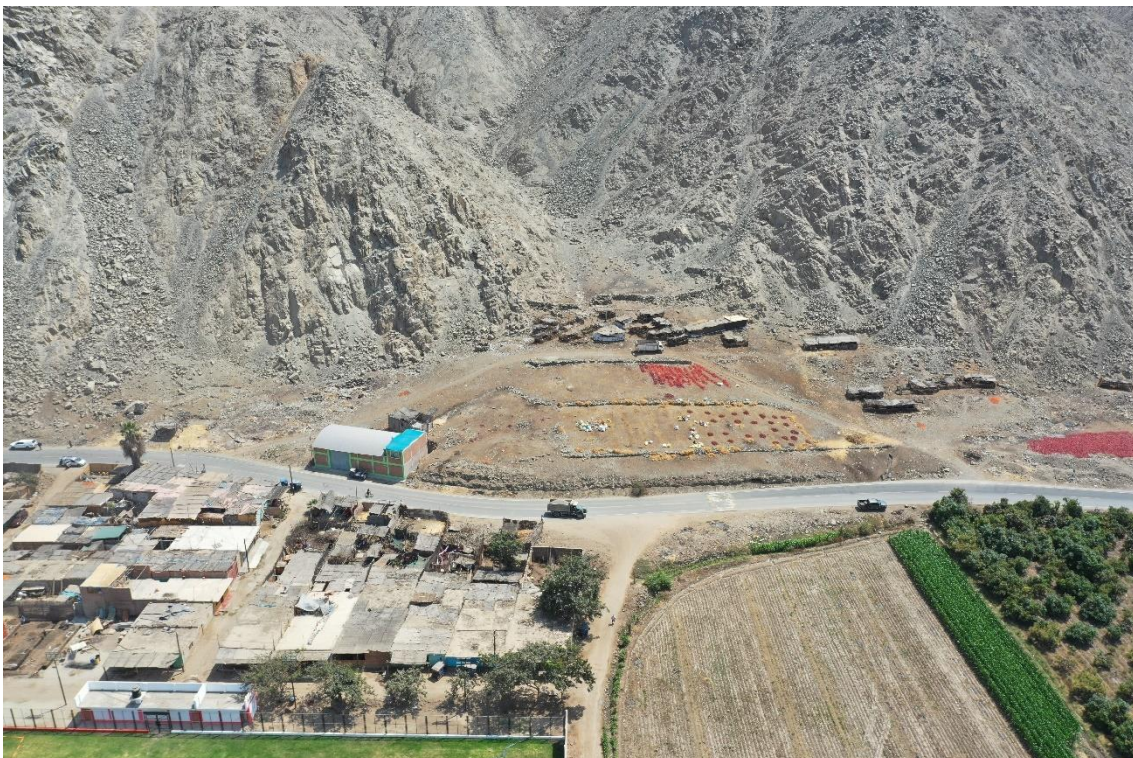
Fotografía 96. Zona crítica 02-121. Parte del poblado de Barbacay, asentada sobre un abanico proluvial, de peligro alto debido al material dispuesto en su cauce, que ante un eventual flujo de detritos afectaría directamente las viviendas. Coordenadas UTM: 8892337/ 172797, Zona 18 L. Tomado el 15-09-2023.
