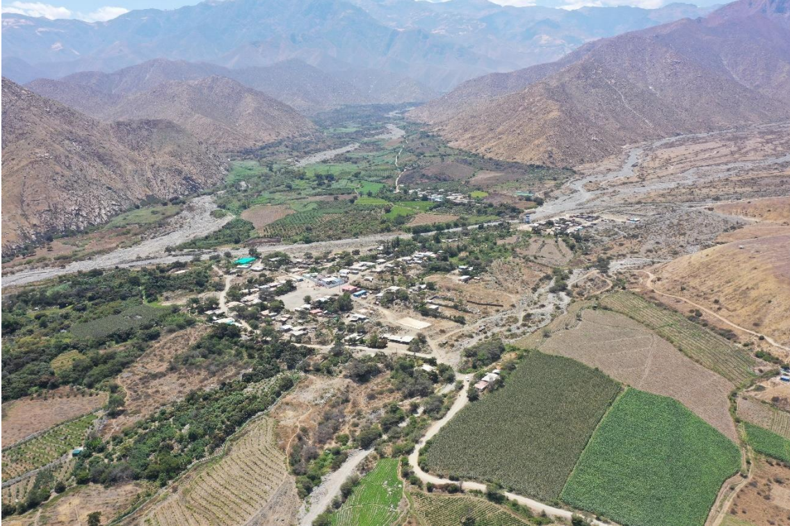
Fotografía 79. Zona crítica 002-101. Zona propensa a ser afectada por flujo de detritos proveniente principalmente de las quebradas Cotapuquio, Pajonal Pampa y Puca Pampa; transportando material suelto disponible en el cauce, sobre todo en períodos excepcionales de lluvias, como lo acontecido el año 2017 y 2023, que afectó viviendas, posta médica e institución educativa.
