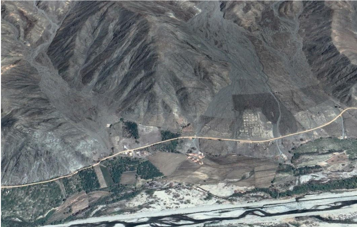
Figura 10. Zona crítica 02-030. Quebrada activada durante el ciclón Yaku en su paso por el sector Pan de Azúcar afectó 15 viviendas de esteras que actualmente se encuentran deshabitadas asentadas dentro del cauce de la quebrada.
