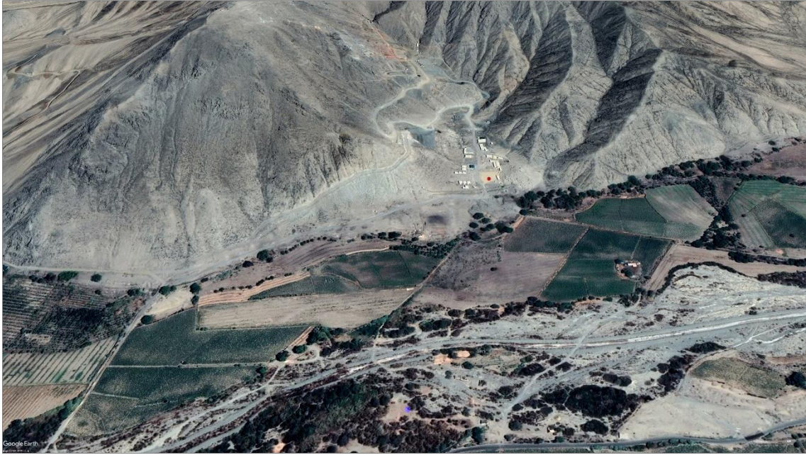
Figura 27. Zona crítica 02-132. Oyo se encuentra asentado en la margen derecha del río Culebras, sobre un depósito proluvio-aluvial, susceptible a erosión fluvial. Coordenadas UTM: 8905727 / 814638, Zona 17 L. Tomado del Google Earth.
