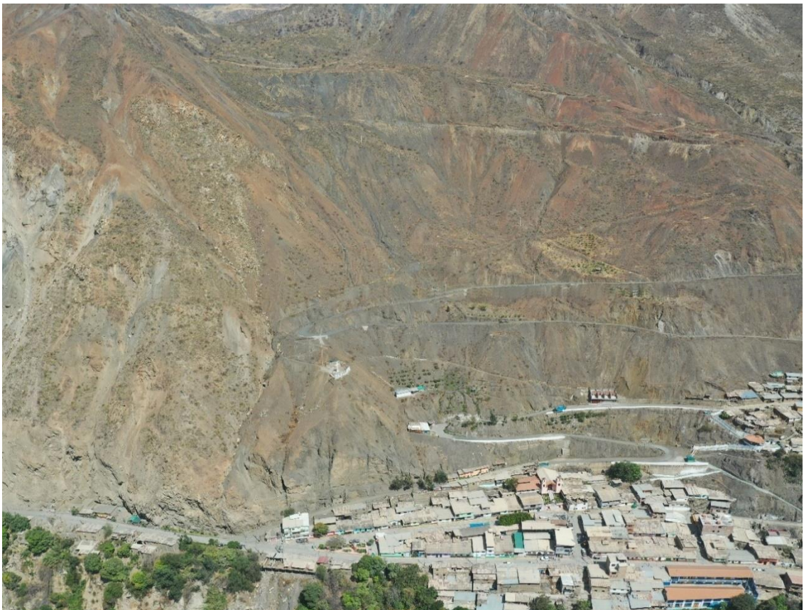
Fotografía 55. Zona crítica 02-043. El poblado de Huallanca se encuentra asentado al pie del deslizamiento, en zonas aledañas alrededor ocurre múltiples reactivaciones de deslizamiento, flujos de detritos, derrumbes, erosión de laderas. Coordenadas UTM: 9023881 / 184835, Zona 18. Tomada el 14-09-2023.
