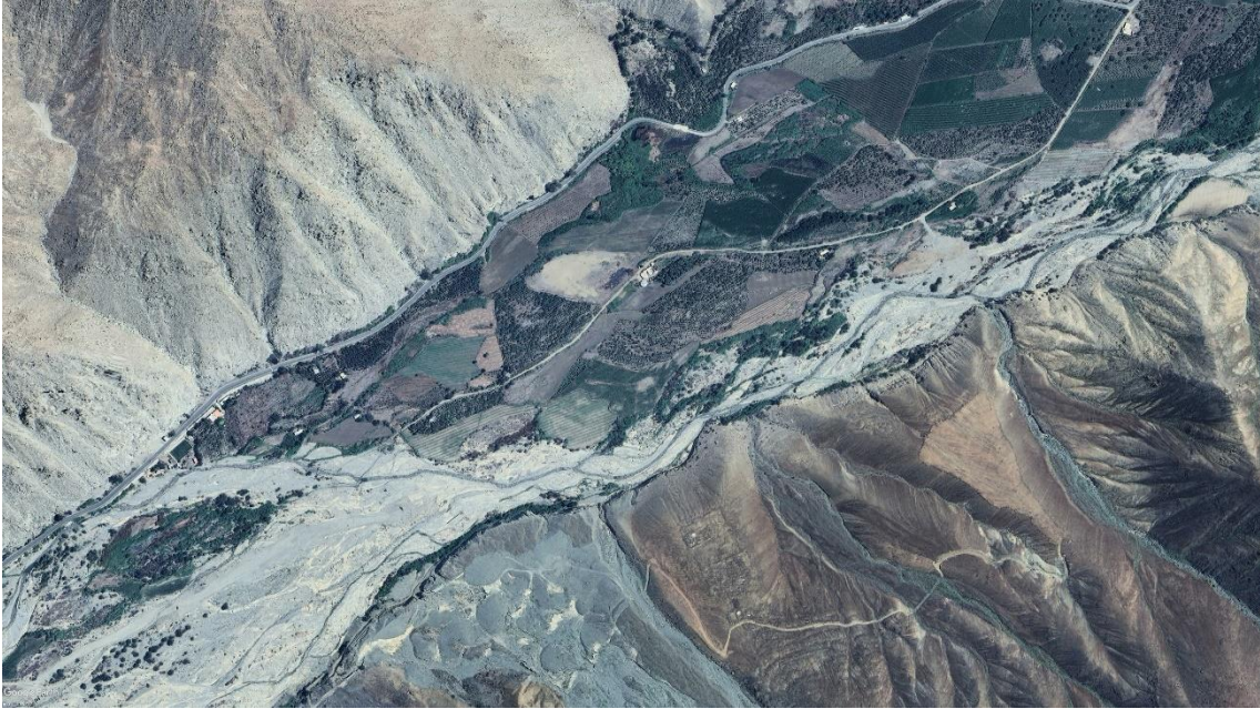
Figura 20. Zona crítica 02- 116. Sector Tres Cruces asentada en la margen derecha del río Huarmey, sobre terrazas aluviales; susceptible a ser afectada por flujo de detritos. Coordenadas UTM: 8895068 / 185866, Zona 18 L. Tomado del Google Earth.
