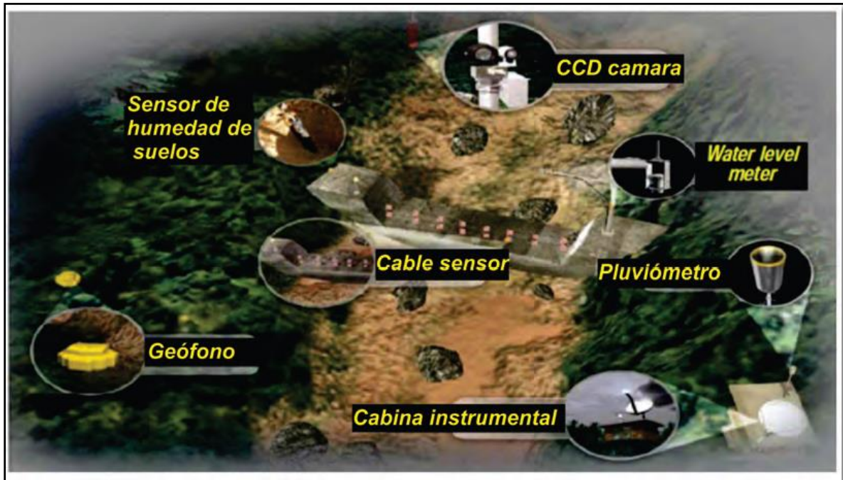
Figura 28. Sensores utilizados para el monitoreo de flujos de detritos (fotografía tomada de Soil and Water Conservation Bureau SWCB-Taiwan, por Vílchez, 2010).
