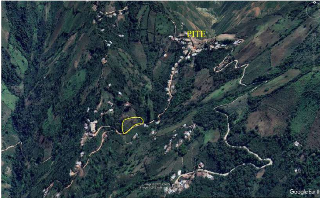
Figura 24.- Depósito coluvial (polígono amarillo) conformado por materiales limo arcillosos e inestables que han sido depositados sobre las laderas
