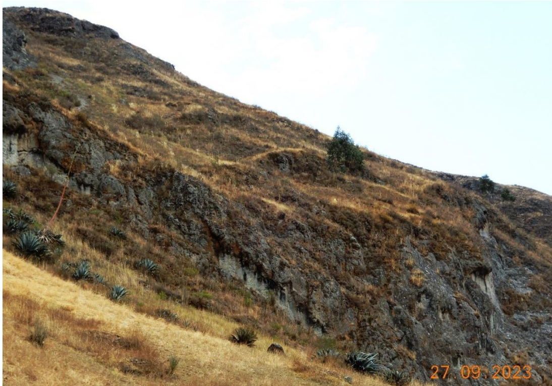
Fotografía 1. Valor GSI estimado para estrato compuesto arcillitas de color gris oscuro Coordenadas. UTM: 768873 / 9126179, Zona 17.
