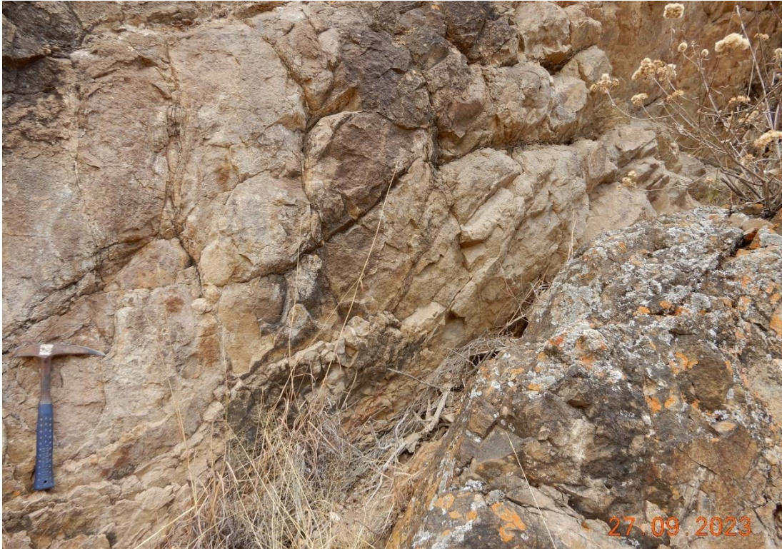
Fotografía 2. Valor GSI estimado para estrato compuesto arcillitas de color gris oscuro. UTM: 768873 / 9126179, Zona 17.
