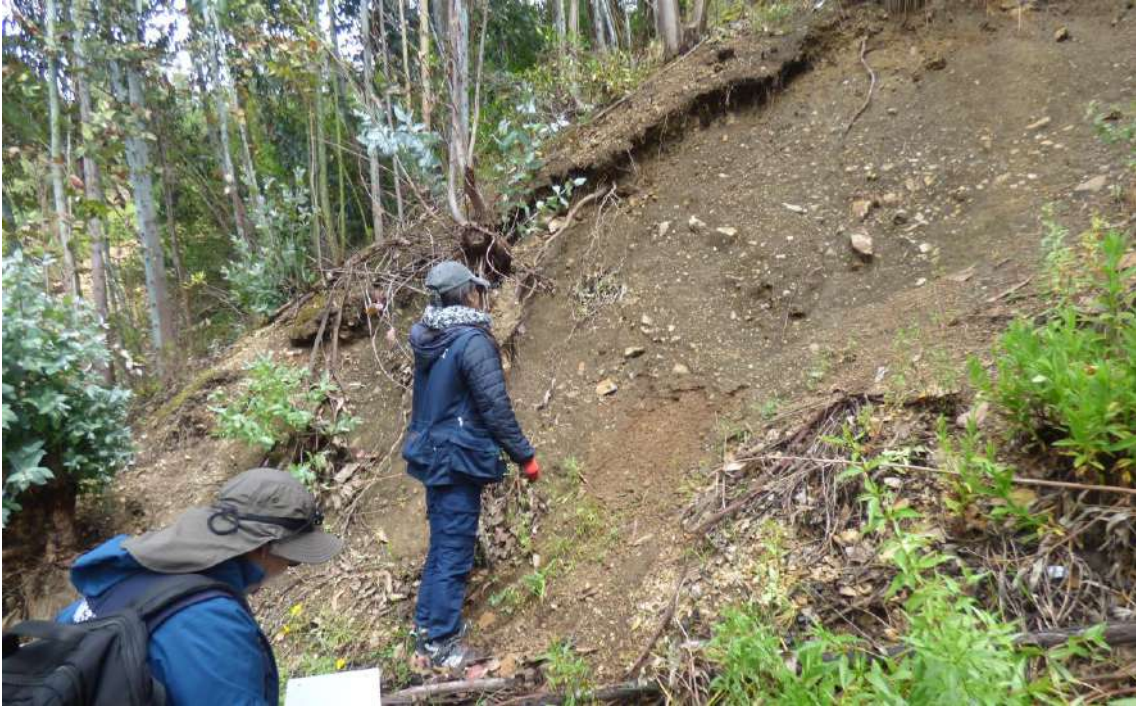
Fotografía 1. Vista del depósito coluvio-deluvial poco consolidado, compuestos por fragmentos de roca angulosos a subangulosos de tamaños variables (4 a 50 cm), envueltos en una matriz limo-arenosa. Granulometría: 10% bloques, 15% gravas, 25% gránulos, 30% arenas, 20% limos y arcillas.
