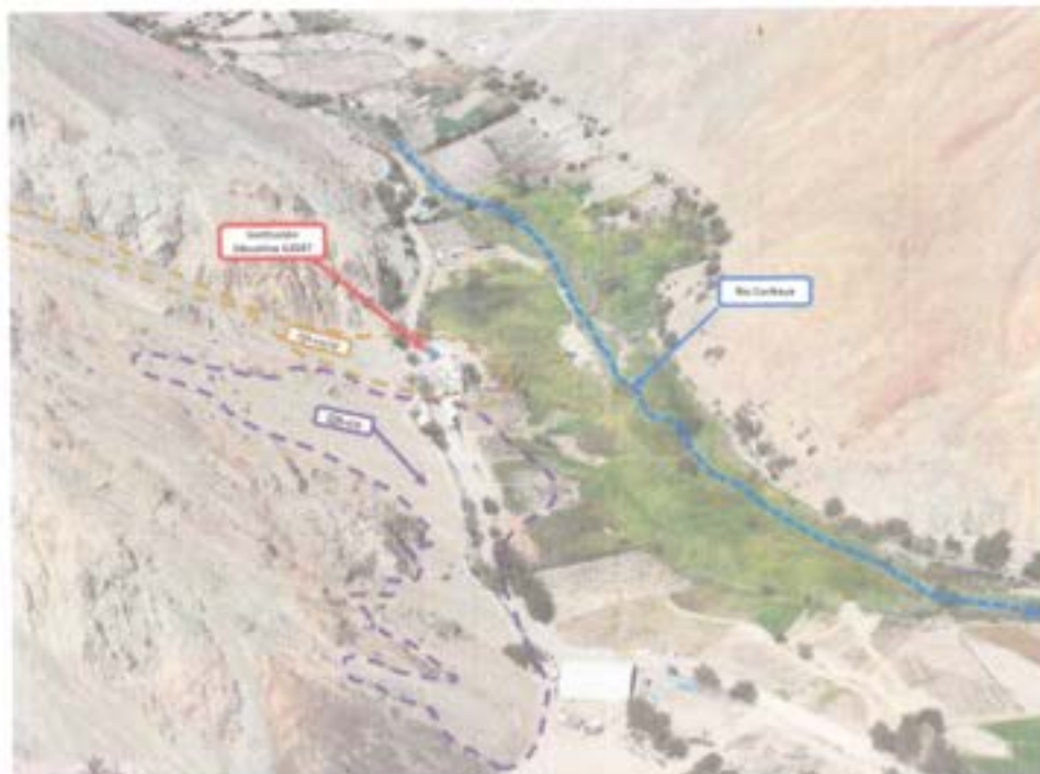
Fotografía 39 Vista de los depósitos coluviales (Qh-co), depositados en la zona superior de la I.E. 42047.
