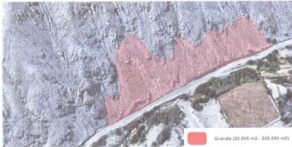
Fotografía 58 Vista de áreas de deslizamiento, en la vertiente de montaña en la margen derecha de la carretera de Anexo Poquera a Puquiña.
