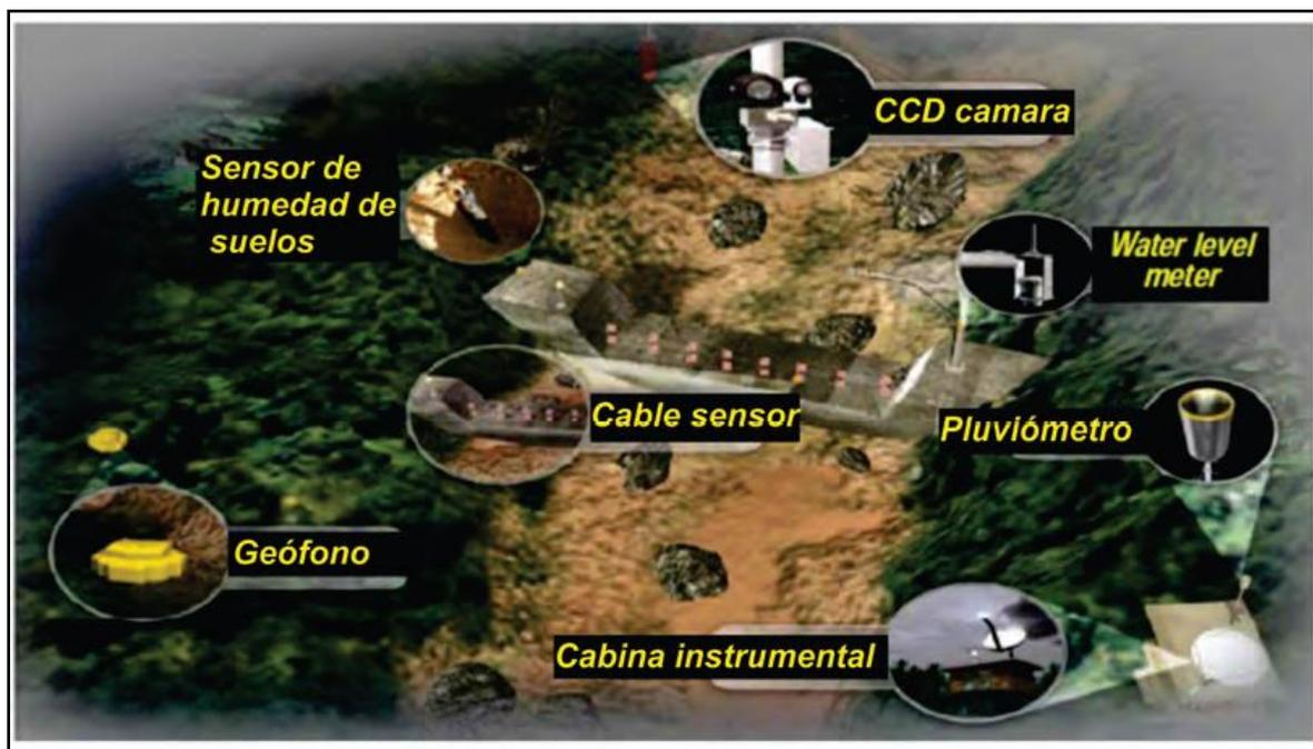
**Figura 21.** Sensores utilizados para el monitoreo de flujos de detritos (fotografía tomada de Soil and Water Conservation Bureau SWCB-Taiwan, por Vílchez, 2010).
