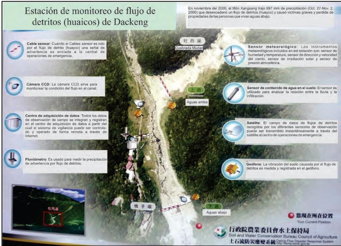
Figura 22. Estación de monitoreo de flujo de detritos (fotografía tomada de Soil and Water Conservation Bureau SWCB-Taiwan, por Vílchez, 2010).
