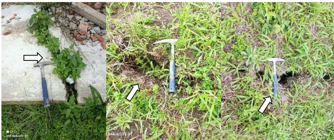
**Figura 16.** Grietas con aberturas mayores a 10 cm y 1 m de profundidad del deslizamiento DRA-1.
