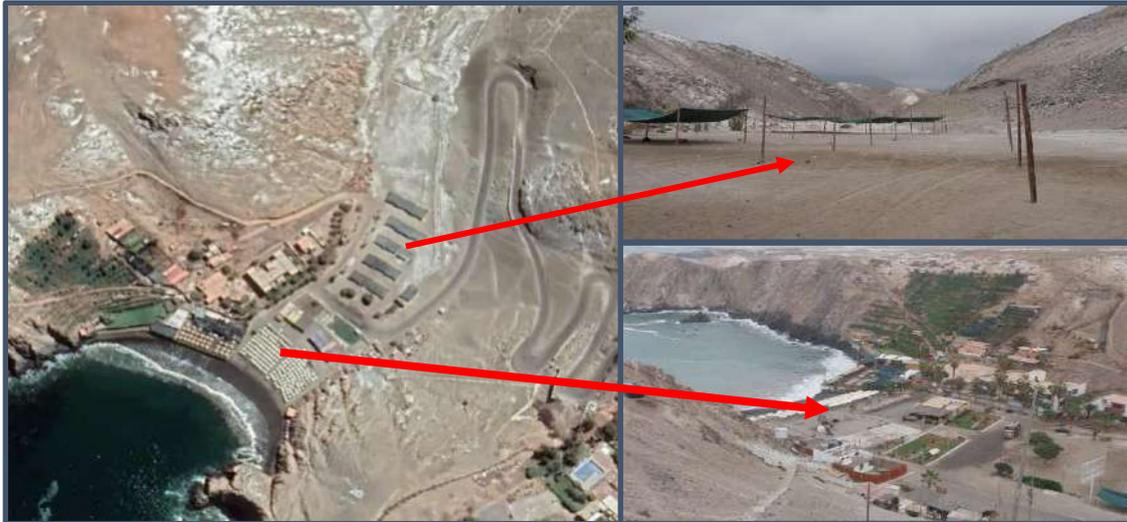
**Foto Nro. 11:** En el sector APVIS 7 de junio y APVIS Progreso: Área sujeta a inundaciones, flujos y sismos, todo este sector se encuentra en la quebrada Chungungo, las viviendas han ocupado el cauce (relleno) y laderas que han sido modificadas. Siendo vulnerable la población ahí asentada y las viviendas, además de calles, centros de recreación, parques y un comedor popular.
