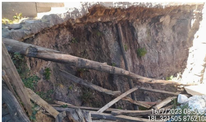
Materiales limo – arenosos con contenido de gravas aisladas que conforman el depósito aluvial antiguo en las inmediaciones de las viviendas del poblado Santa Cruz de Andamarca.
