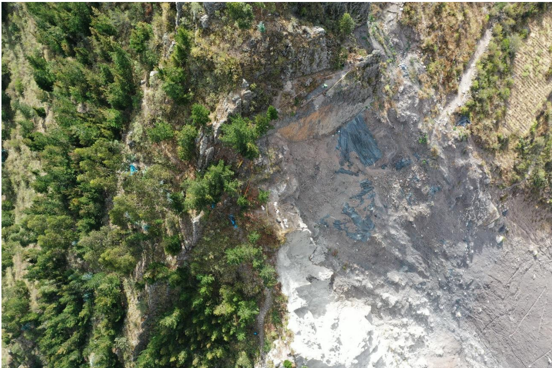
Fotografía 2. Zona superior del derrumbe, se observa agrietamientos en el contacto, roca- suelo.
