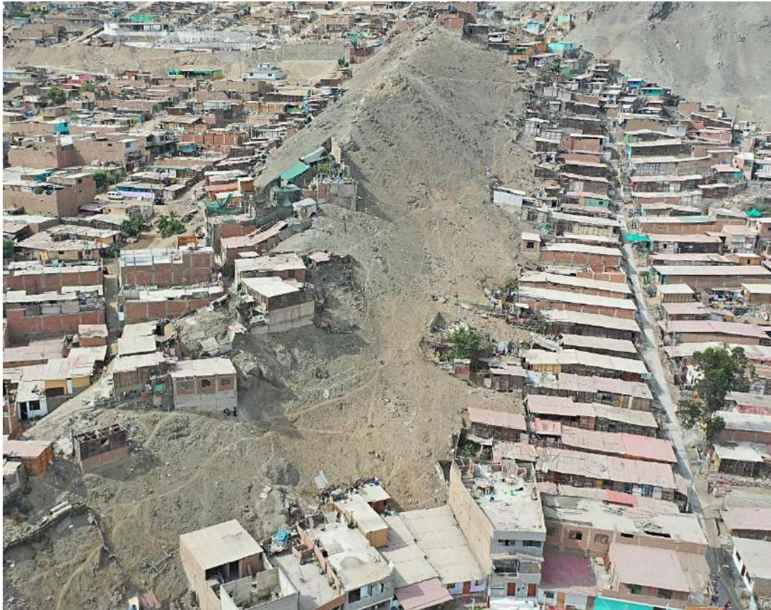
Fotografía 4. Vista de la subunidad de lomada modelada en rocas volcanosedimentaria. Sus relieves se encuentran asociadas a procesos dominantes de caídas de rocas y derrumbes. Coordenadas referenciales UTM WGS-84, 18S: E: 269420; N: 8688755.
