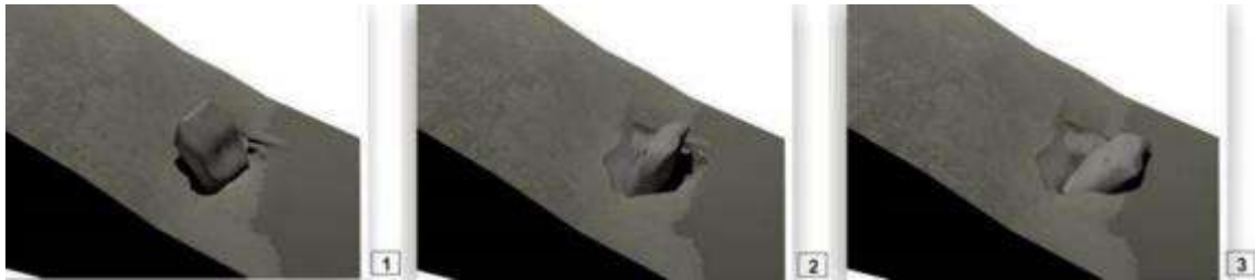
Figura 30: Tratamiento de un bloque suelto en suelo potente.
