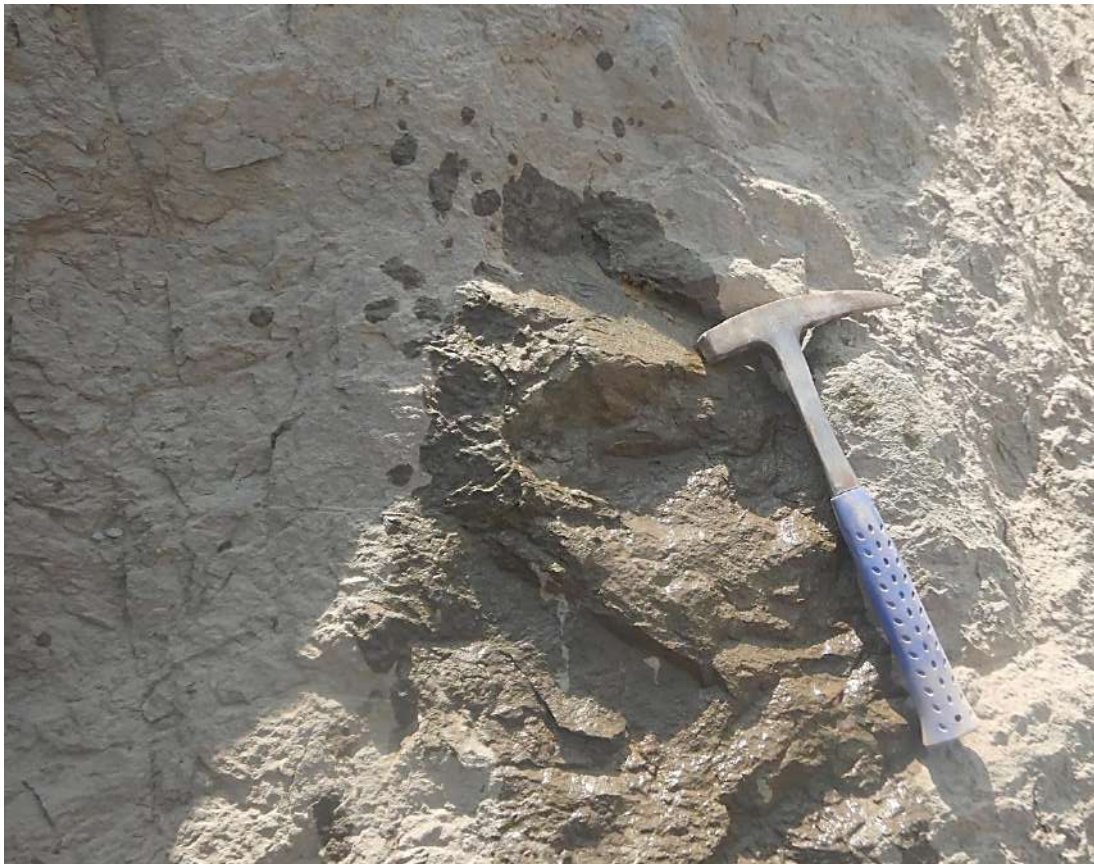
Fotografía 1. Vista del substrato rocoso constituido por areniscas volcanoclásticas, de coloración verde a gris, granulometría fina a gruesa de la Formación Ventanilla. Superficialmente se muestra el sistema de fracturamiento, con espaciamentos muy próximos a próximos entre sí, aberturas algo abiertas y sin relleno visible. Coordenadas referenciales UTM WGS-84, 18S: E: 269348; N: 8688666.
