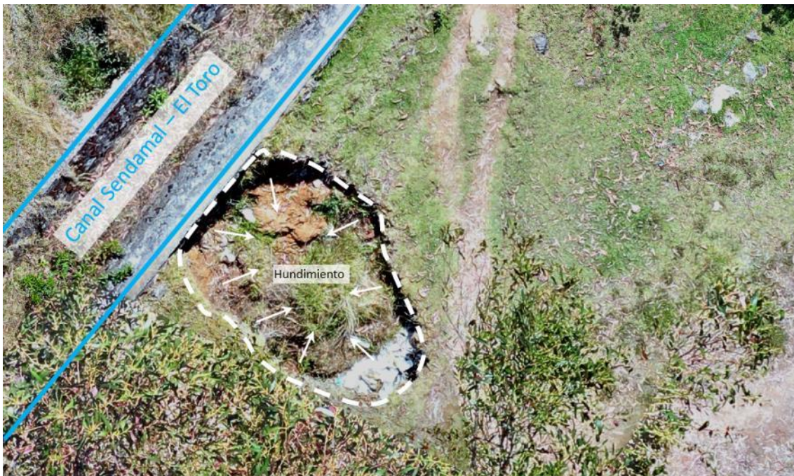
Figura 12. Se observa el hundimiento relleno con material de la zona. Coordenadas UTM, WGS-84, 17S. Norte: 9239947 y Este: 809834.
