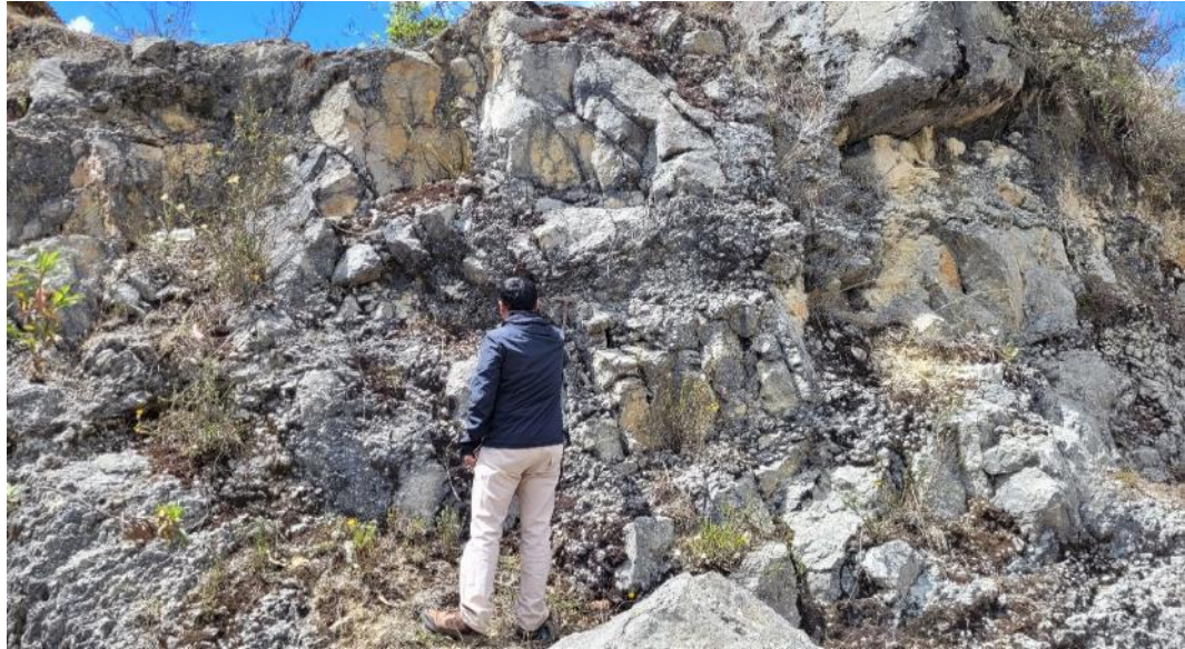
Fotografía 1. Calizas altamente meteorizadas y medianamente a muy fracturadas, Formación Cajamarca. Coordenadas UTM, WGS-84, 17S. Norte: 9239851 y Este: 809479.
