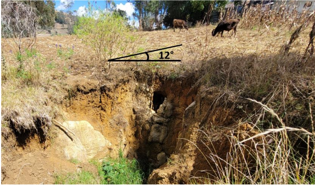
Figura 4. La ladera donde se desencadenó el hundimiento (H1), pendiente promedio de 12^\circ .
