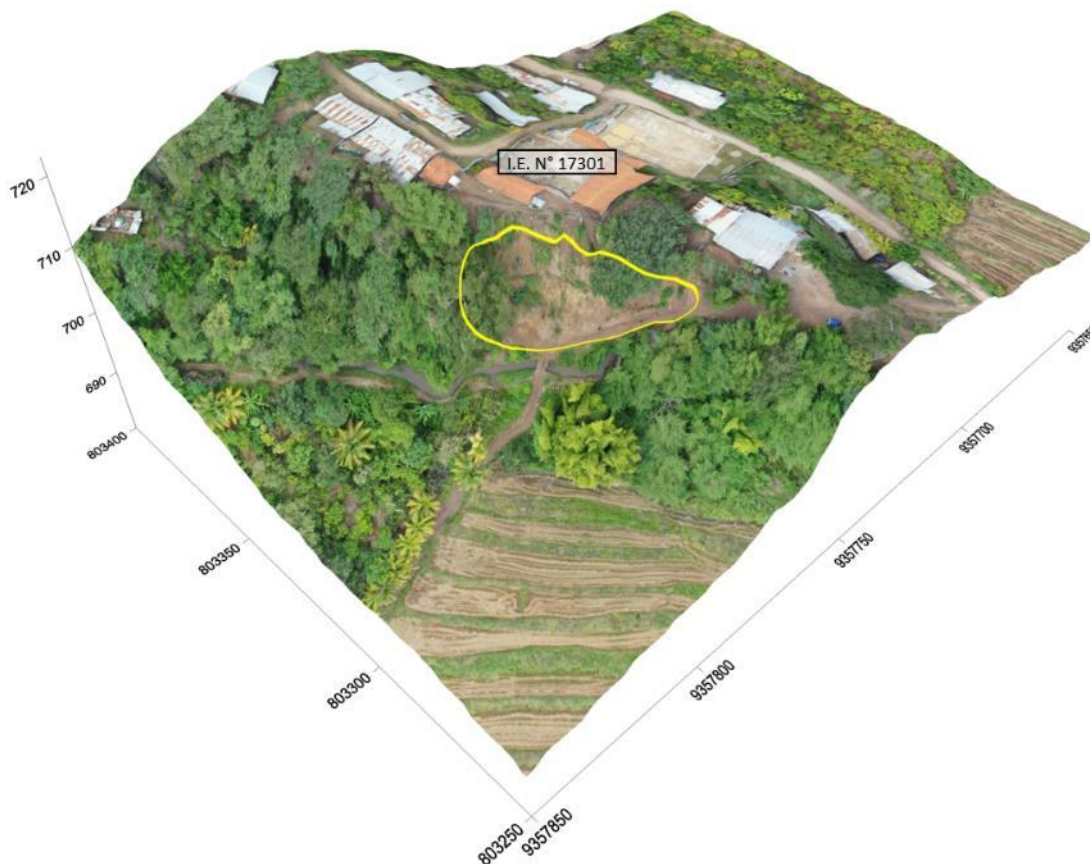
Figura 7. Modelo 3D del centro poblado Naranjitos Alto, el deslizamiento está delimitado en línea amarilla, se aprecia la Institución Educativa expuesta al peligro parte alta del movimiento en masas.
