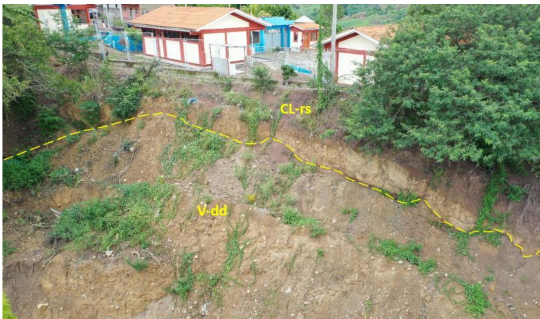
Figura 5. Vista de las geoformas de colina y lomada en roca sedimentaria (CL-rs) y vertiente con depósito de deslizamiento (V-dd), en el centro poblado Naranjitos Alto.
