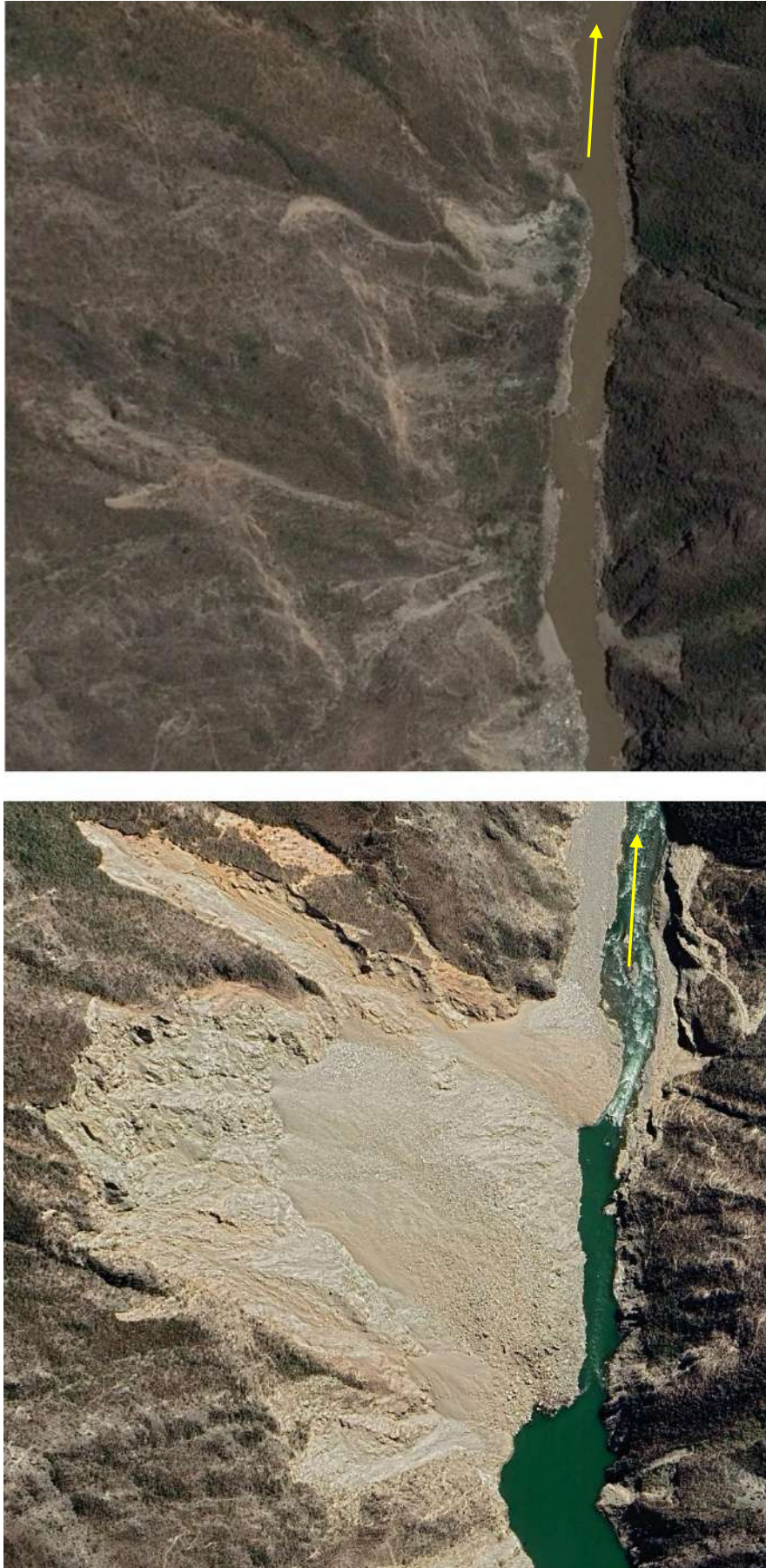
Figura 11. Comparación de imágenes satelitales entre el año 2013 y 2024 donde se observa cambios morfológicos ocasionado por el derrumbe del 13 de junio del 2024.
