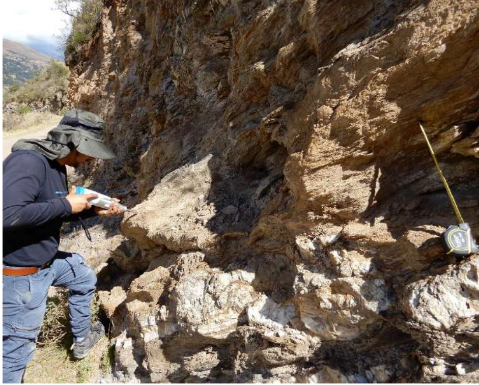
Fotografía 4. Ensayo con martillo de Schmidt del macizo rocoso. UTM: 303680 / 8961884, Zona 18.
