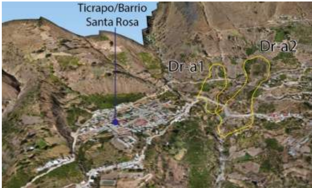
Figura 15. Muestra el deslizamiento Dr-a2, activo, rotacional.
