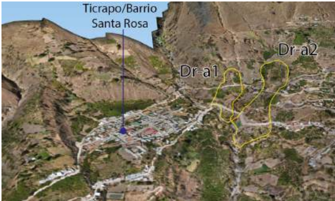
Figura 14. Muestra el deslizamiento Dr-a1, en base a la información fotogramétrica en la ladera oeste de Ticrapo.
