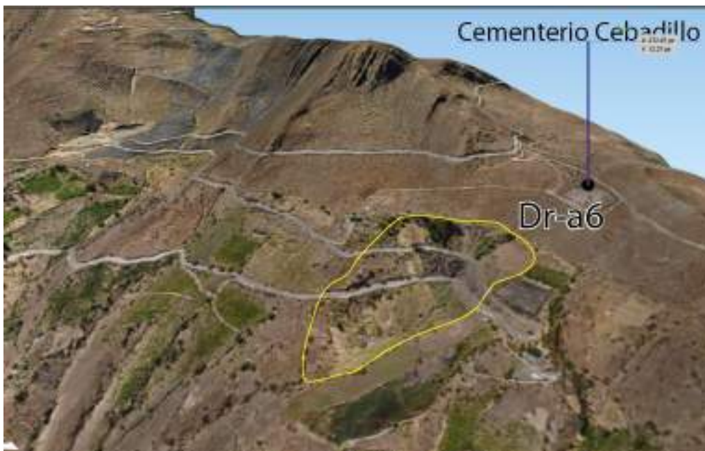
Figura 21. Muestra el cuerpo del deslizamiento Dr-a6 activo.
