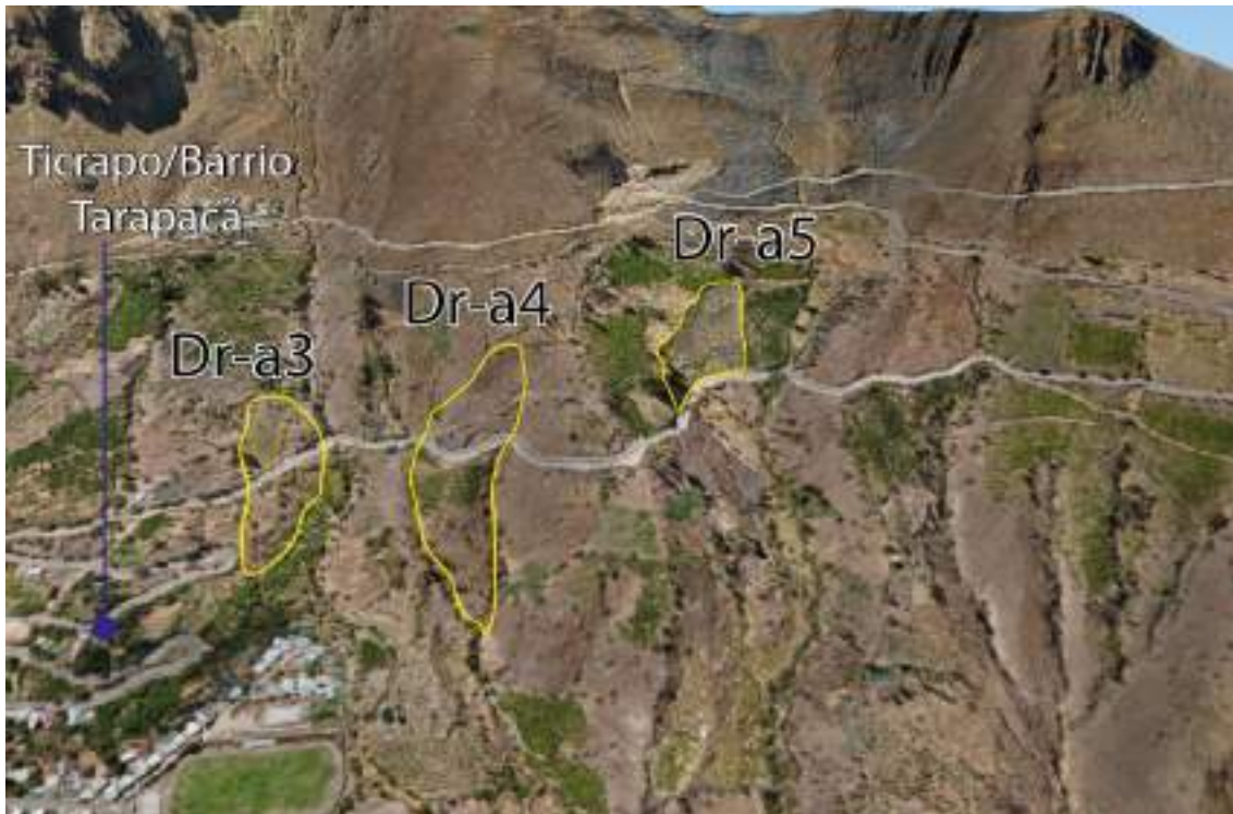
Figura 16. Muestra el deslizamiento Dr-a3, activo, rotacional cercano al barrio Tarapacá.
