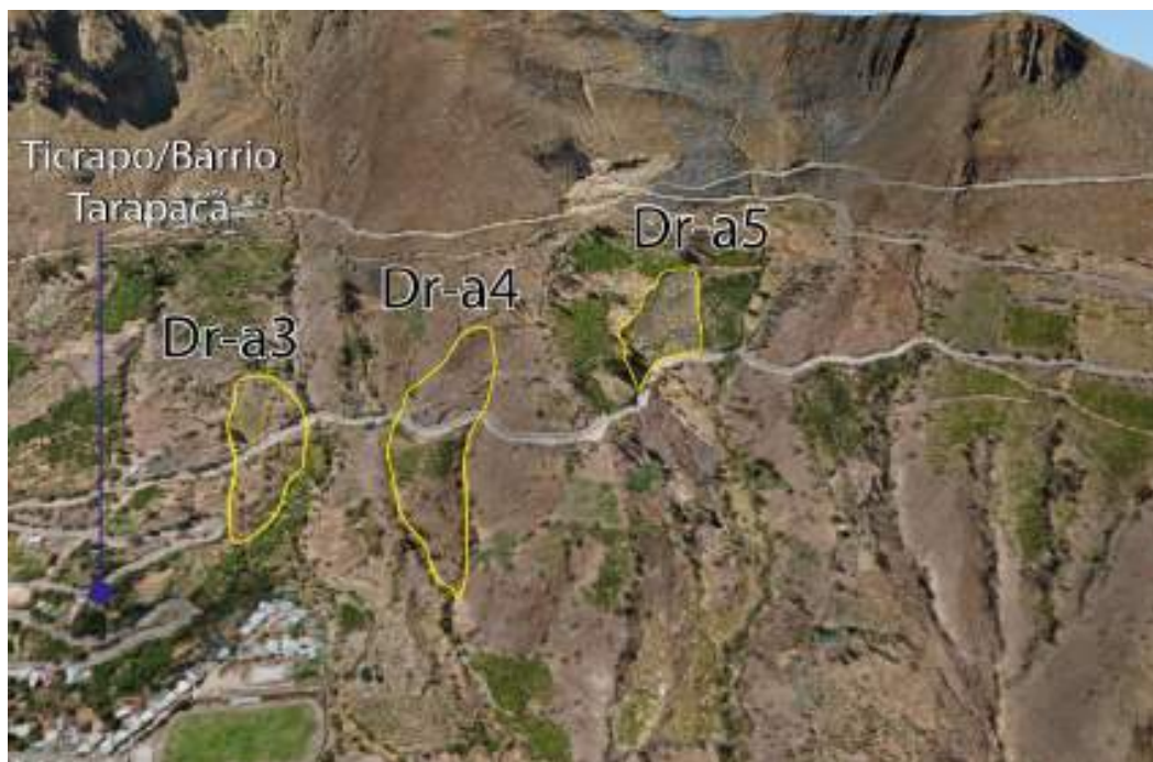
Figura 18. Muestra el deslizamiento Dr-a4, activo, entre los deslizamientos Dr-a3, Dra5.
