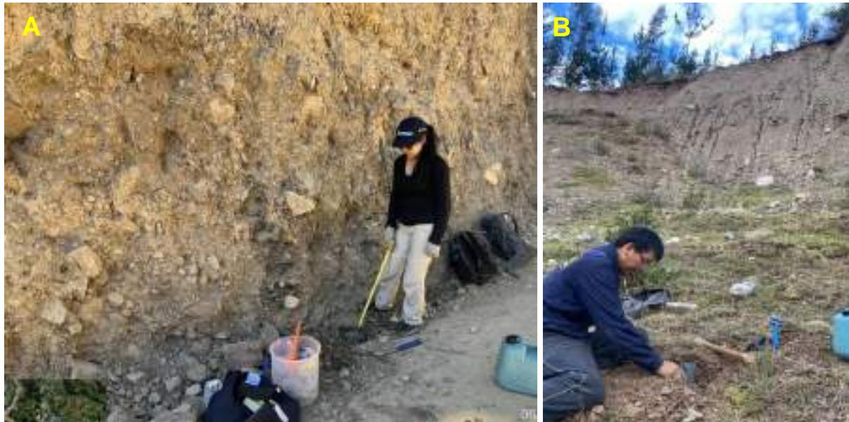
**Figura 7.8.** Ensayo de infiltración en depósitos coluvio - deluviales, a) EI-09 en la trinchera (T-04). b) EI-15 en la parte baja del colegio, en dirección al río.
