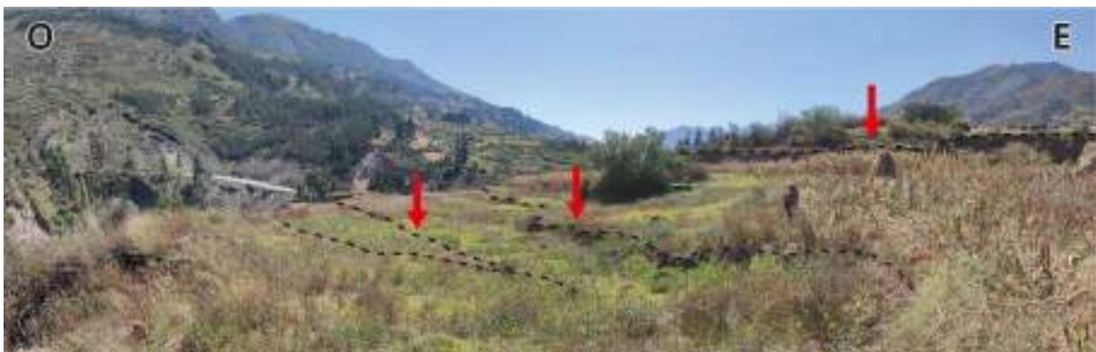
**Figura 5.16.** Asentamiento escalonado del terreno (líneas negras punteadas y flechas rojas), con dirección del movimiento al oeste.
