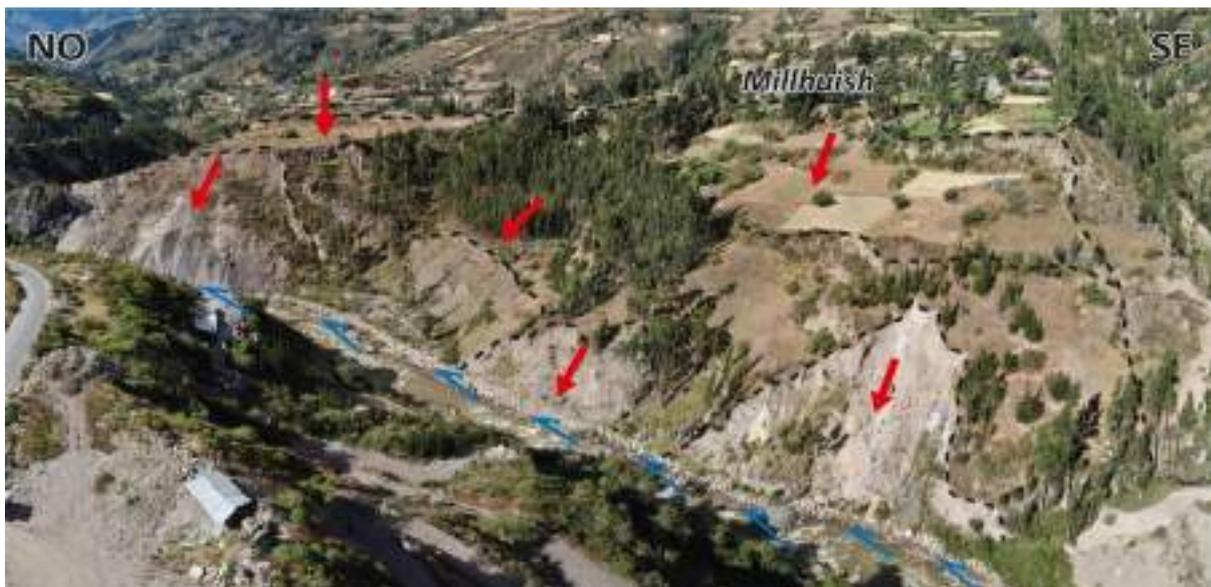
**Figura 5.13.** Vista del pie de la avalancha donde se ubica el poblado de Millhuish, se observa reactivaciones en forma de deslizamientos y derrumbes que afectan el poblado.
