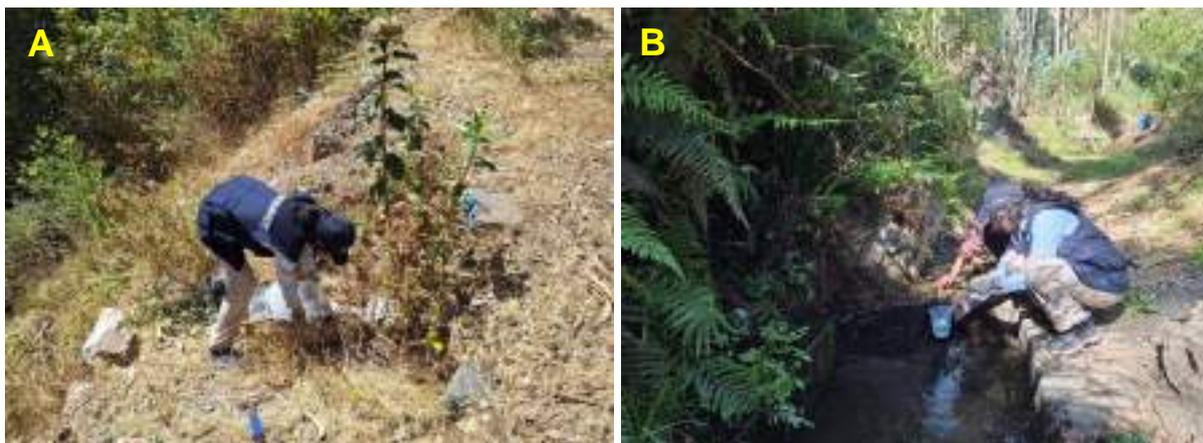
**Figura 7.2.** A) Aforo de caudal método volumétrico en la quebrada Raja. B) Manantial captado de código 498996-016. Presenta un caudal de 2.60 l/s.
