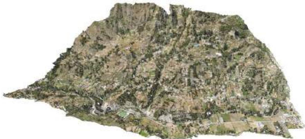
**Figura 11.19.** Nube de puntos calculada a partir del levantamiento fotogramétrico.
