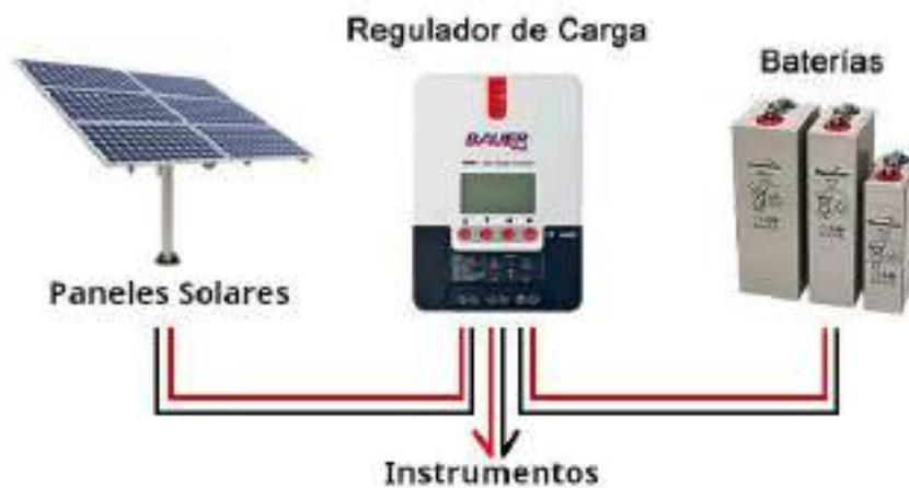
**Figura 11.11.** Imagen referencial de sistema de alimentación eléctrico autónomo.
