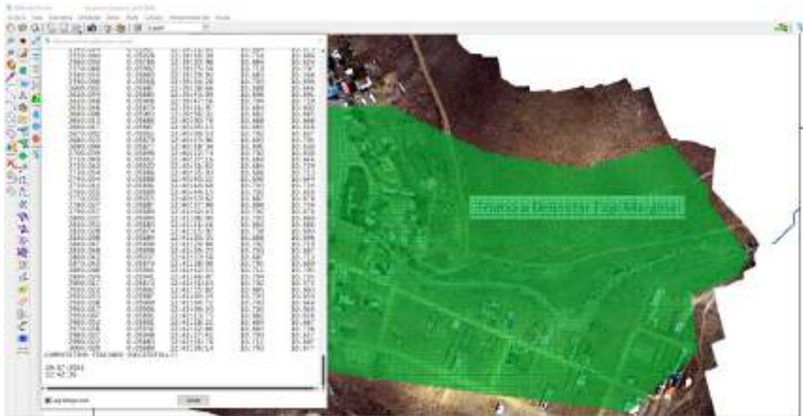
Ilustración 34 - Simulación Iber en la Quebrada La Huaylla Sector Yanayaco. para periodo de retorno de 100 años
