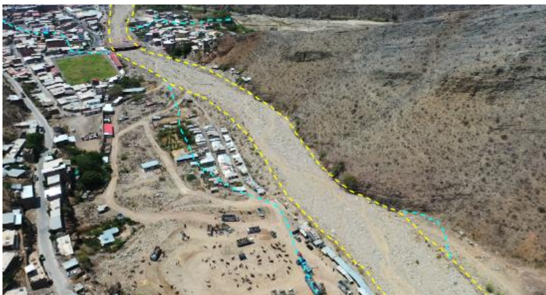
Figura 10. Sobreposición de las áreas impactadas por flujos de detritos en la quebrada Huertas, a un caudal de 351.17 m 3 /s (en amarillo) y 656.63 m 3 /s (en celeste).
