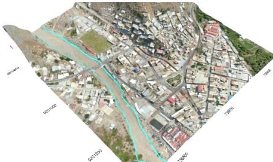
Figura 8. Demarcación de la zona afectada por flujo de detritos durante la temporada de lluvias en la quebrada Huertas, a un caudal de 351.17 m 3 /s.
