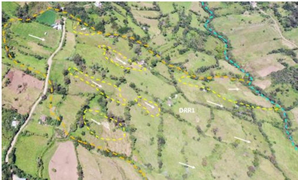
**Figura 12.** Deslizamiento rotacional reactivado DRR1 (en línea anaranjada) y sus reactivaciones (en línea amarilla); la quebrada Tosten está delimitada en línea celeste.
