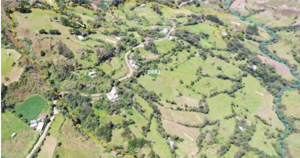
**Figura 14.** Deslizamiento rotacional reactivado DRR2 (en línea anaranjada) y sus deslizamientos rotacionales activos (en línea amarilla); la quebrada Tosten está delimitada en línea celeste.
