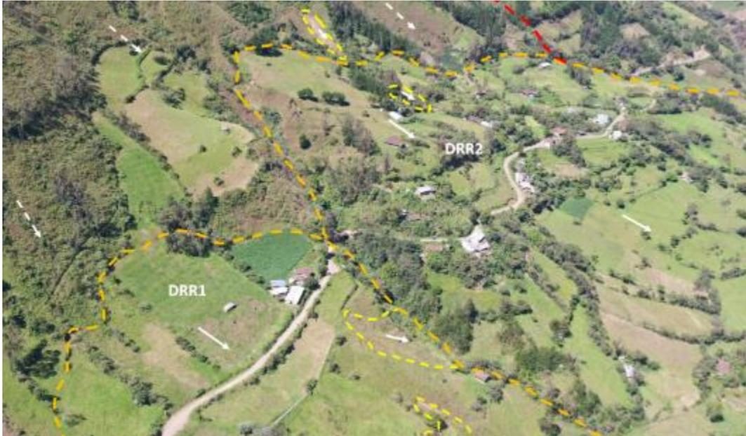
**Figura 10.** Vista de los dos deslizamientos rotacionales reactivados (DRR) delimitados en línea naranja, el deslizamiento relicto está delimitado en línea roja y los deslizamientos activos en línea amarilla.
