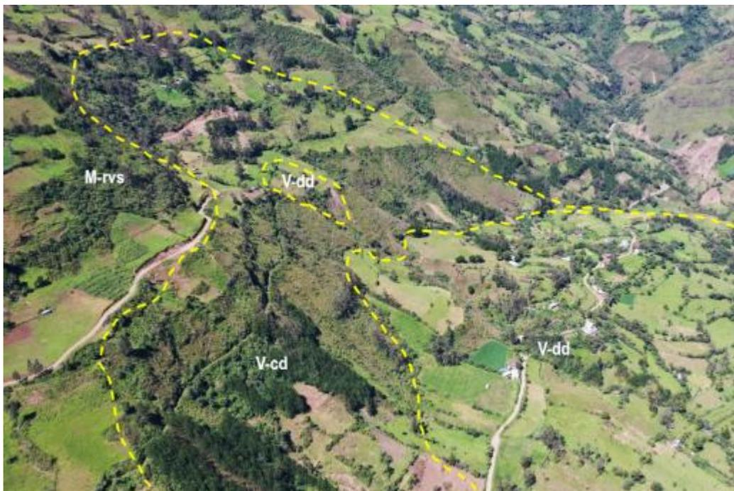
**Figura 7.** Geofomas cartografiadas en la localidad de El Potrero: Montaña en roca volcánico sedimentaria (M-rvs), vertiente coluvio deluvial (V-cd) y vertiente con depósito de deslizamiento (V-dd).
