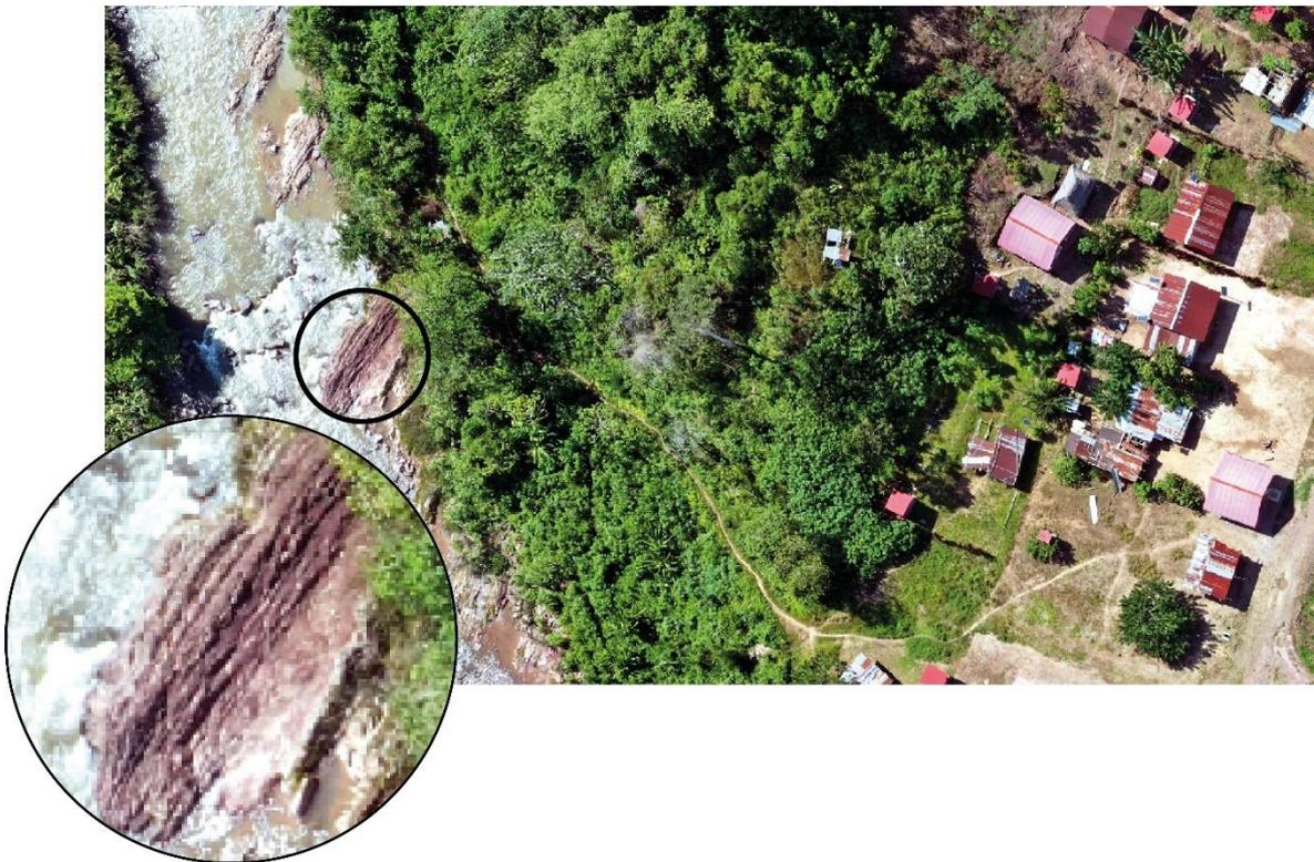
**Figura 5:** Areniscas calcáreas intercaladas con lodolitas y margas en el área de estudio WGS 84, 18s, X: 507702; Y: 8822410.
