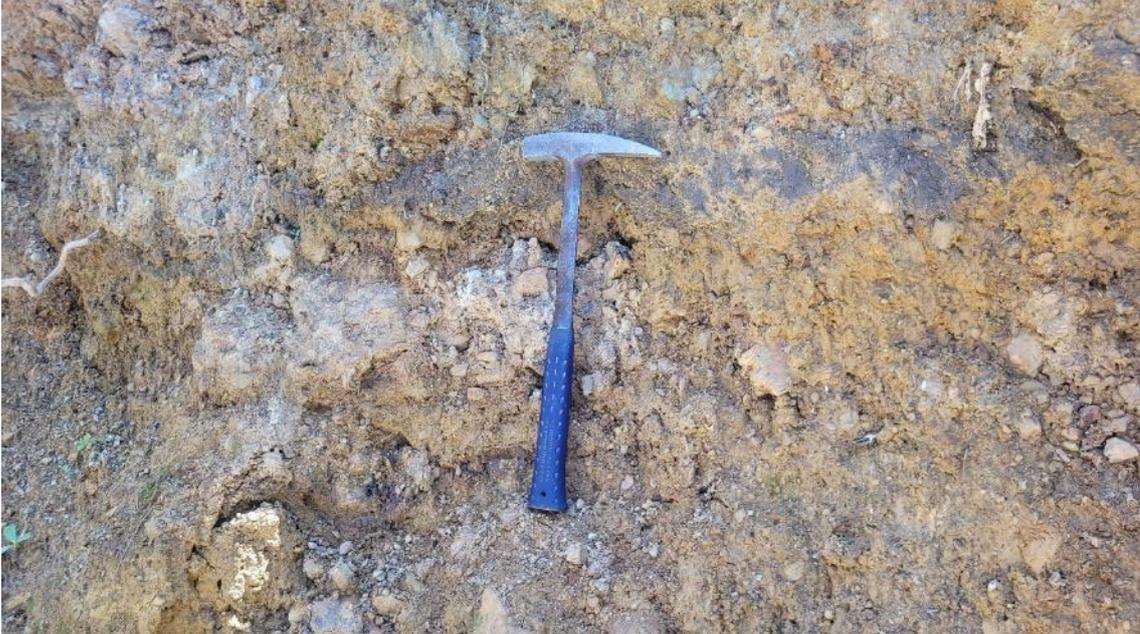
**Fotografía 2.** Depósito coluvio -deluvial, ubicado en la zona de deslizamiento en Querocoto. Coordenadas UTM WGS84 17M. 717472, 9296543.
