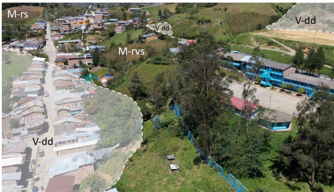
**Figura 10.** Vista de las geoformas de montaña en rocas sedimentarias (M-rs), montaña en rocas volcánico sedimentarias (M-rvs) y vertiente con depósito de deslizamiento (V-dd), en la localidad de Querocoto.
