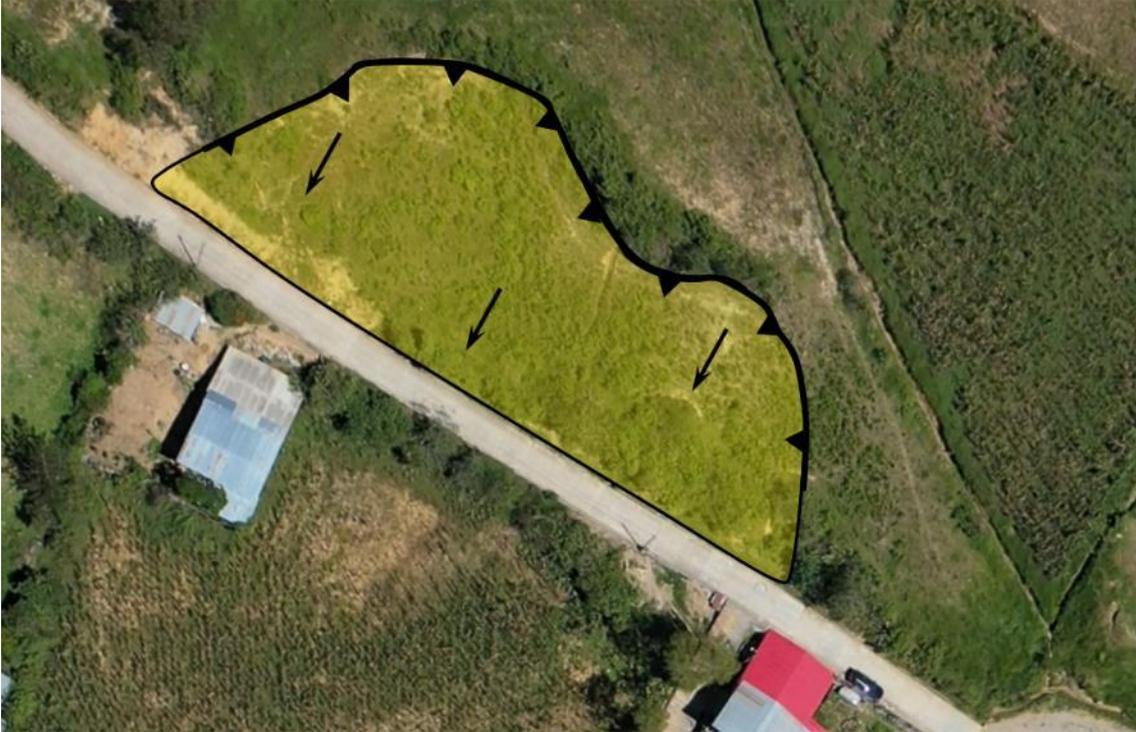
**Figura 22.** Viviendas expuestas al deslizamiento activo – DA4.
