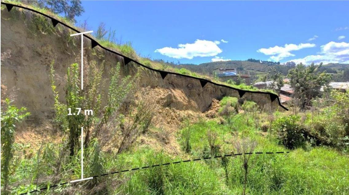
**Figura 14.** Salto vertical del deslizamiento activo – DA1.
