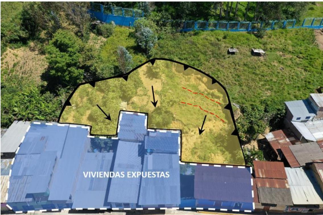
**Figura 14.** Viviendas expuestas al deslizamiento activo – DA1.
