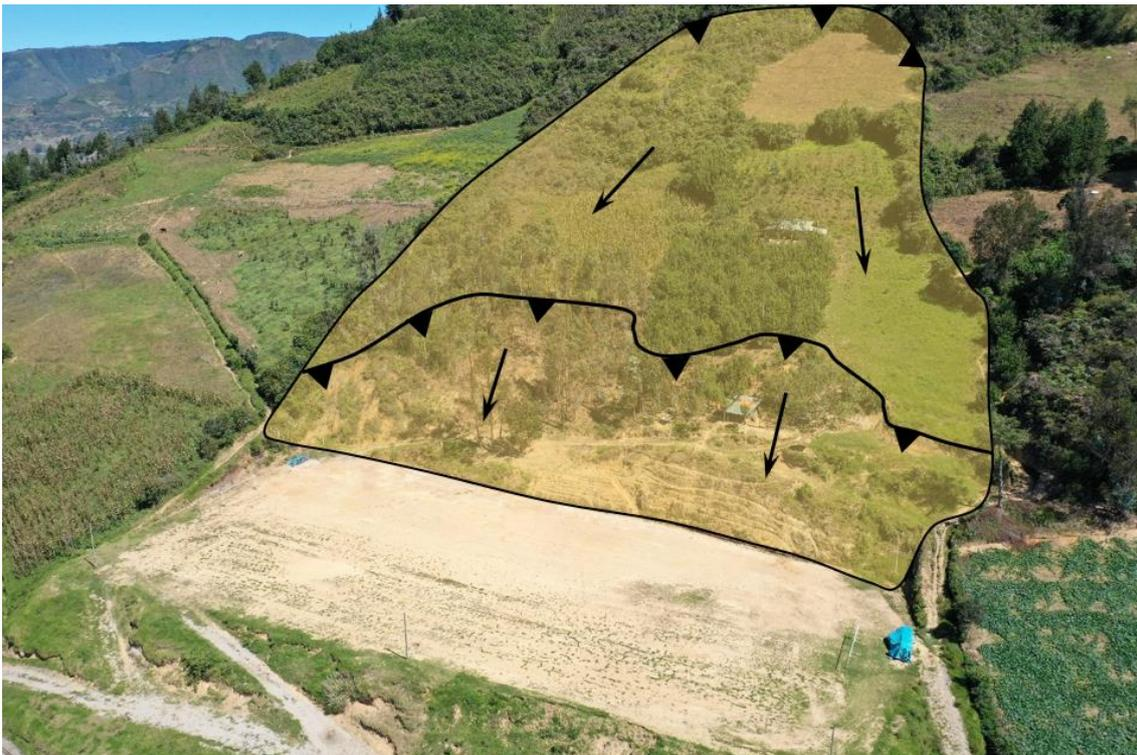
**Figura 21.** Deslizamiento ubicado al suroeste de plataforma deportiva.
