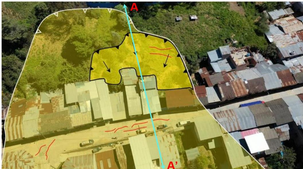
**Figura 12.** Localidad de Querocoto, se observa el deslizamiento rotacional activo – DA1 (línea negra), dentro del cuerpo de deslizamiento– DA2 (línea blanca), compromete viviendas y vía; con presencia de agrietamientos (línea roja).
