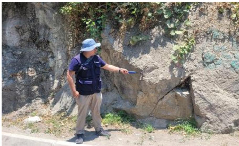
**Fotografía 2.** Corte de talud en la localidad de La Mónica, donde se aprecian secuencias de flujos piroclásticos muy fracturados y altamente meteorizados. Ubicación: E: 731701 y N: 9200501.
