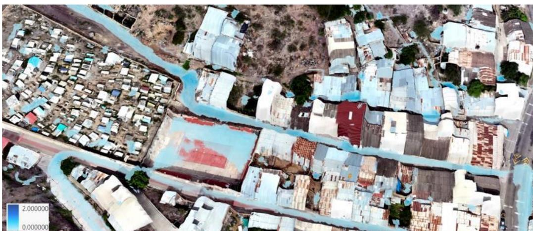
**Figura 15.** Modelamiento de flujos considerando lluvias intensas en Llálan, donde se aprecia la altura de inundación que pueden alcanzar los flujos.
