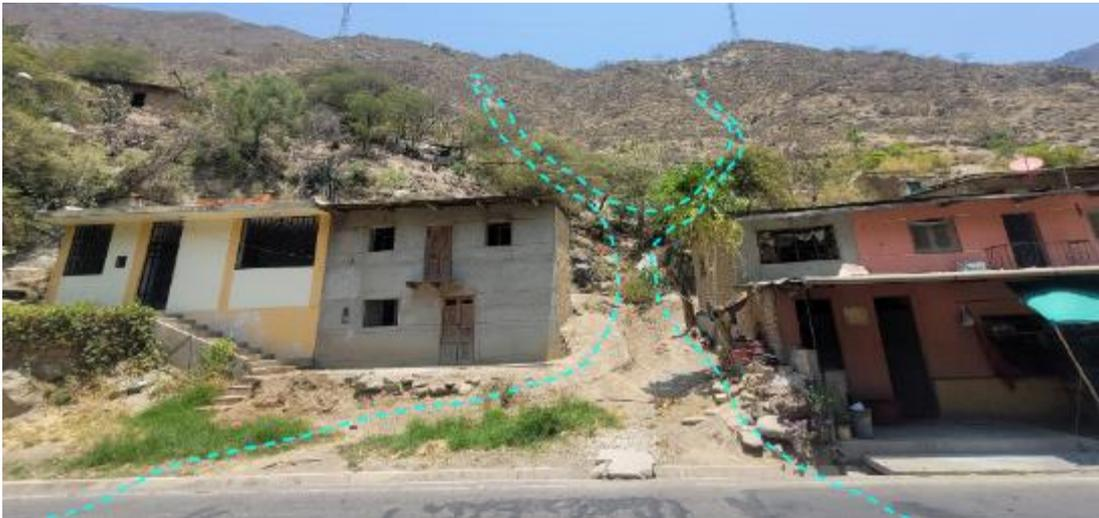
**Figura 16.** Demarcación de la zona afectada por flujo de detritos durante la temporada de lluvias en La Mónica.
