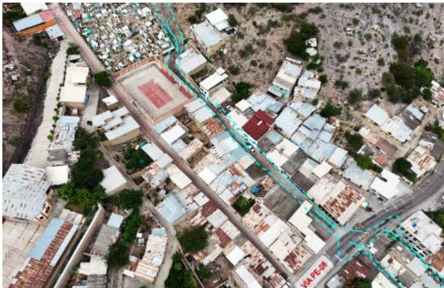
**Figura 14.** Demarcación de la zona afectada por flujo de detritos durante la temporada de lluvias en Llálan.
