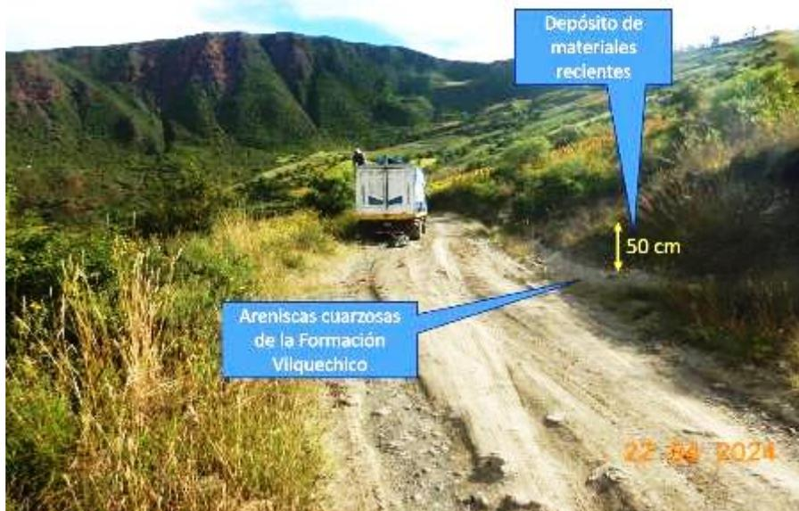
**Figura 4:** Espesores de suelos que cobertura los substratos rocosos de areniscas.
