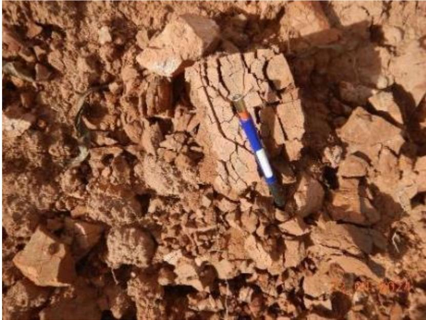
**Fotografía 2:** Lodolitas rojizas, se presentan muy fracturadas a fragmentadas y altamente meteorizadas.
