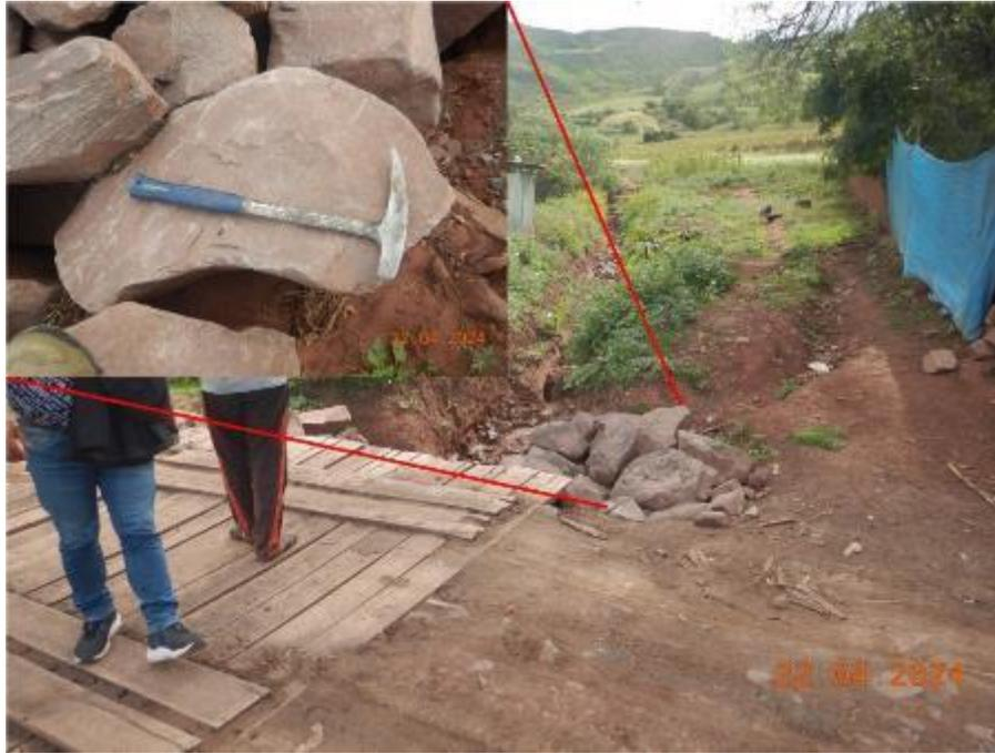
**Figura 2:** Depósitos coluvio deluviales compuesto por bloques y gravas envueltas en matriz areno limosa.
