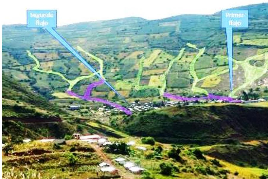
**Figura 3:** En verde se aprecian las torrenteras naturales con procesos de carcavamiento que confluyen en tres canales principales de color morado por donde discurrieron los flujos de detritos que alcanzaron al centro poblado.
