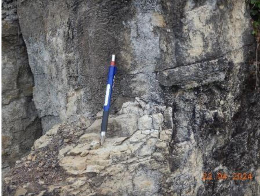
**Fotografía 1:** Arenisca cuarzosa, medianamente a muy fracturada y moderadamente meteorizada.
