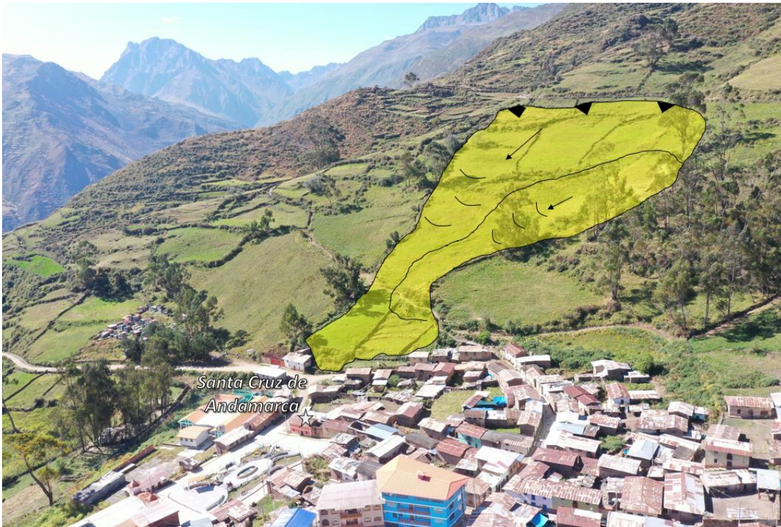
Figura 10. Vista del deslizamiento tipo rotacional reactivado, que podría afectar viviendas, Institución Educativa y terrenos de cultivo. Coordenadas UTM WGS 84: E: 321680; N: 8762188.
