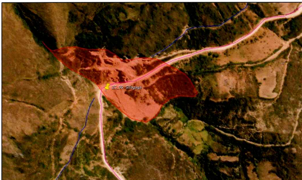
Ilustración 27. Técnica de sifonaje, deslizamiento en el talud y plataforma de la carretera y flujo de lodos.
