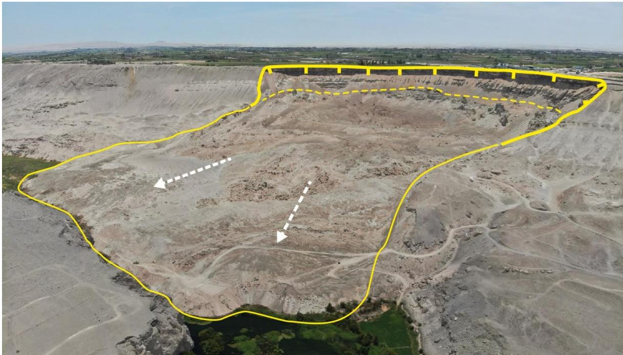
**Figura 2.** Interpretación del deslizamiento de Alto Sigwas, realizada en base a fotografía aérea tomada con dron. La línea gruesa de color amarillo muestra la corona del deslizamiento, la línea entrecortada señala el contacto entre la masa y el plano de deslizamiento y la línea delgada, el límite a junio del 2023. Se aprecia el estrechamiento del valle y cauce original a consecuencia del avance de la masa deslizada (Ingemmet, 2024).
